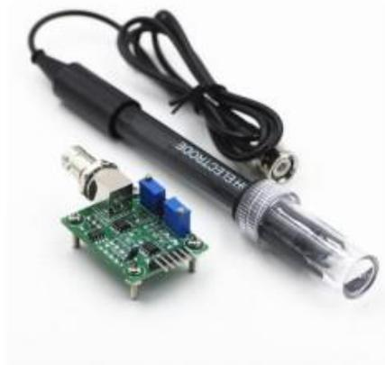
*Figura 25. Sensor de PH-4502C. Información tomada de amazon.com. Elaborado por el autor*
