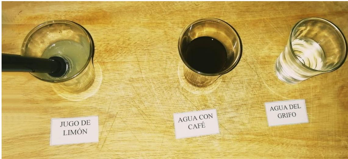
**Figura 39.** Líquidos de pruebas para el medidor de pH.
