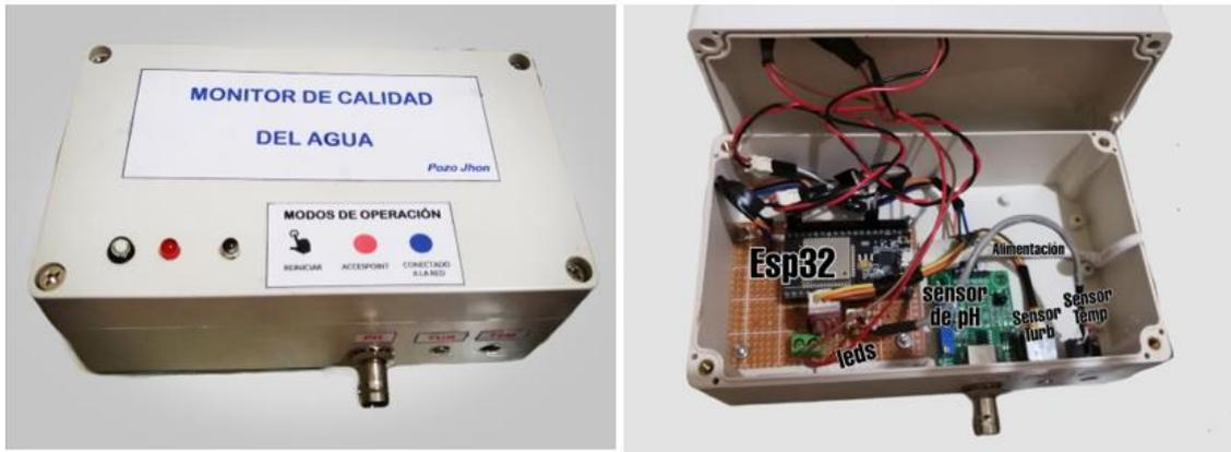
Figura 37. Montaje de los componentes en su caja de proyectos.
