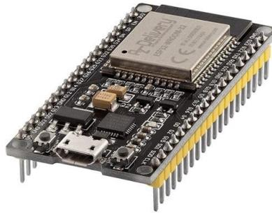
*Figura 12. Esp32 Microcontrolador. Información obtenida de [espressif.org](https://www.espressif.com/) Elaborado por el autor.*
