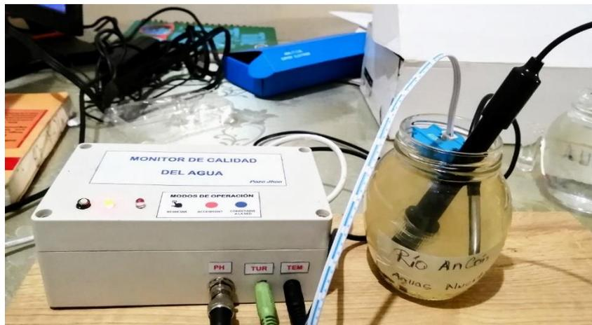
**Figura 42.** Frasco de vidrio lleno de agua del río con los sensores.
