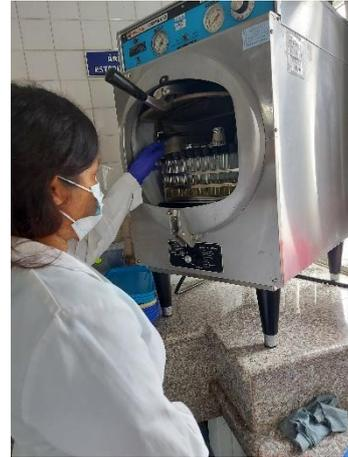
**Anexo 6:** Colocación del material en el autoclave
