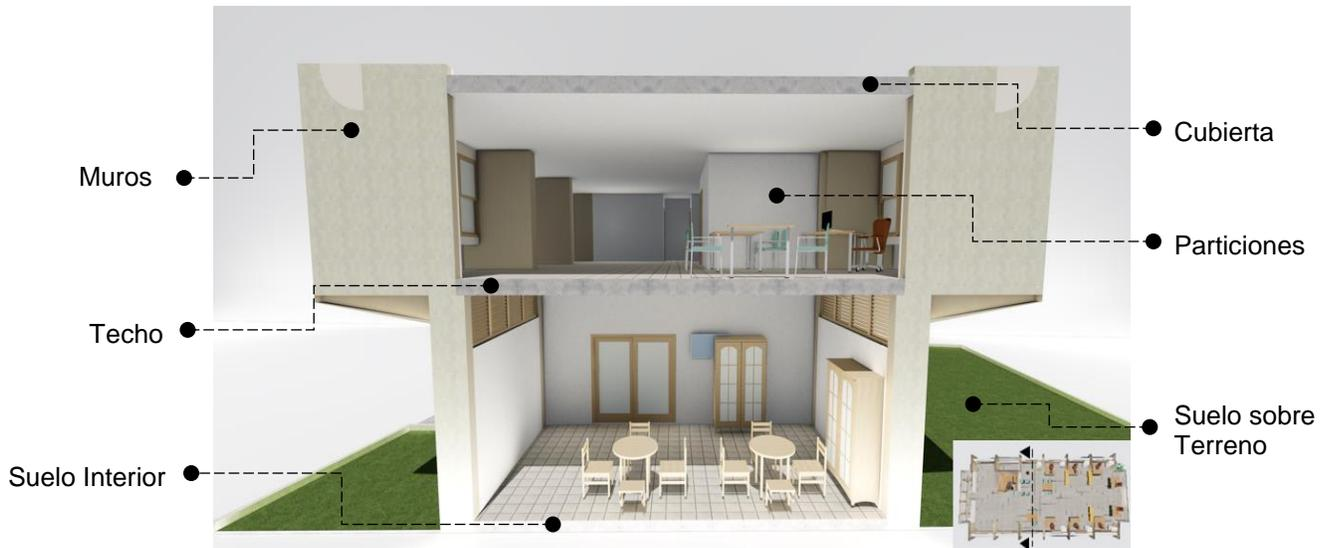
*Figura 22. Vista de parámetros que generan ganancias solares por elementos constructivos del edificio Asociación de Profesores*
