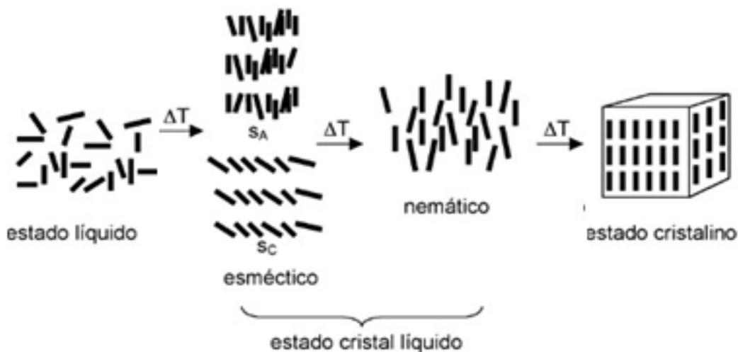
Figura 5. Estado físico de los cristales líquidos
