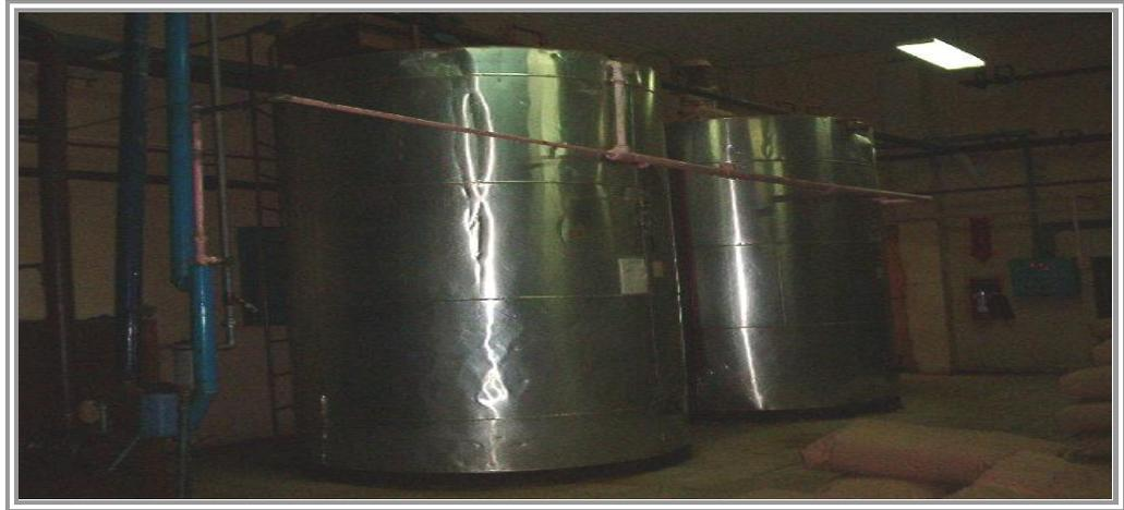
**Fuente:** Ecuacocoa. Tanques metálicos verticales con sistema de serpentines para mantener la temperatura de la masa
