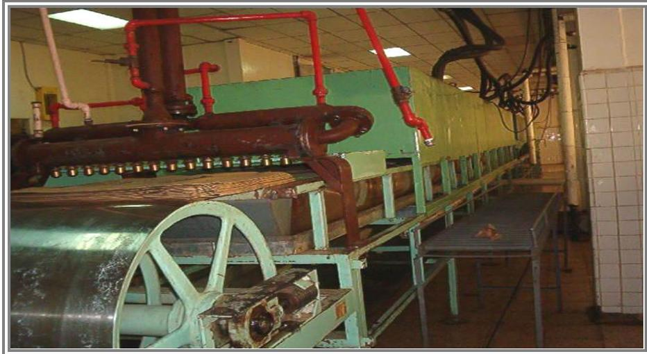
**Fuente:** Ecuacocoa. Túnel de enfriamiento del licor kibble con boquillas de inyección, sistema de enfriamiento por aire frío y agua helada
