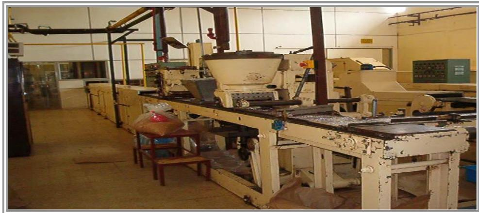
**Fuente:** Ecuacocoa. Dosificadores de chocolate donde se agrega el cereal, banda transportadora con sistema de vibración para amalgamar la maza
