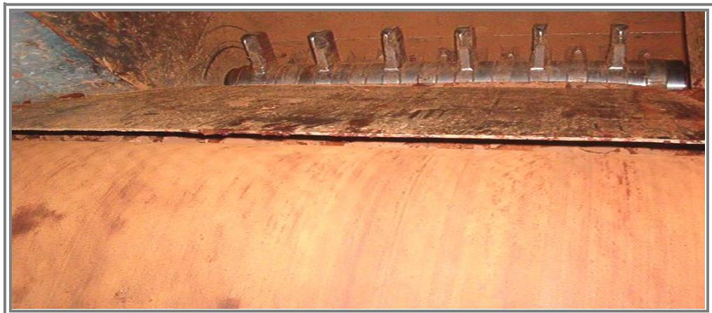
**Fuente:** Ecuacocoa. Martillo rompedor de torta, sistema de cuchillas.
