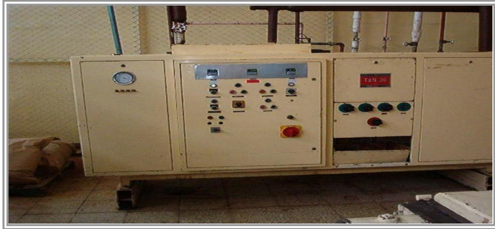
**Fuente:** Ecuacocoa. Máquina para mantener a una temperatura de 27° C la maza.
