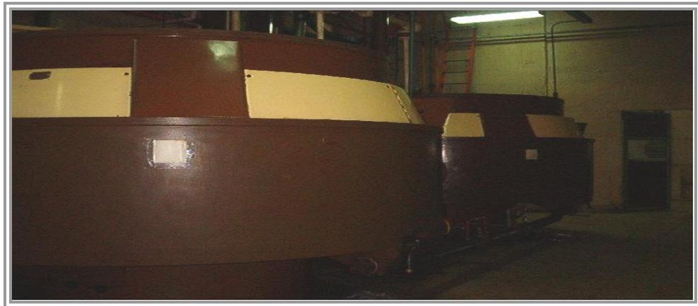
**Fuente:** Ecuacocoa. Conchas para chocolate con capacidad de 4 500 kilos cada una, con u trompo de granito para el conchado.
