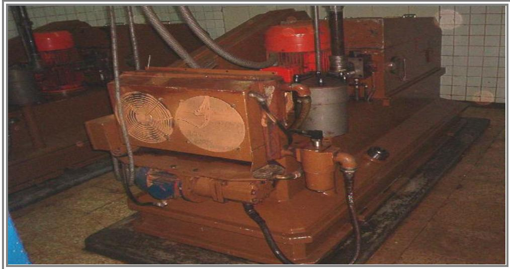
**Fuente:** Ecuacocoa. Compresor tipo tornillo de aceite hidráulico para dar la presión neumática a la prensa, cada unidad cuenta con un compresor.
