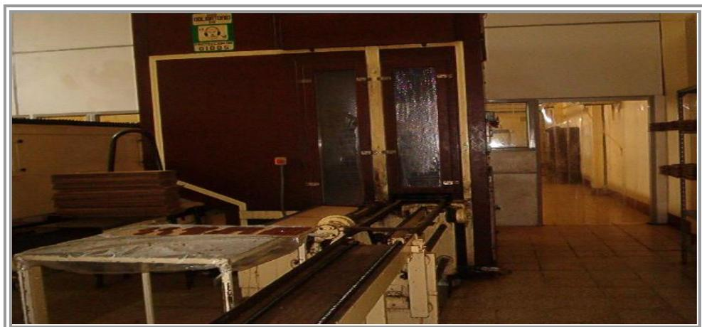
**Fuente:** Ecuacocoa. Túnel de salida del producto terminado, se deposita en cartones y se coloca en estanterías metálicas hasta que adquiere la consistencia y dureza.
