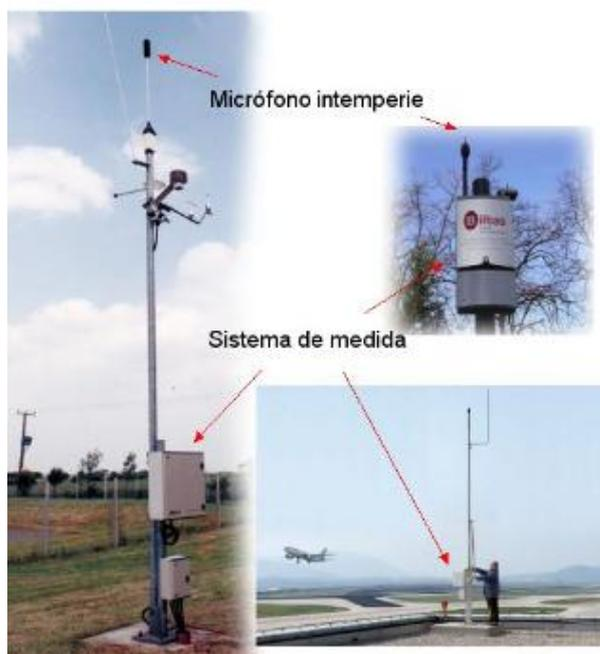
*Fig. 1 – TERMINALES DE MONITOREADO DE RUIDO*
