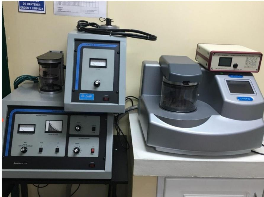
**GRÁFICO 13:** (Freire H, 2017) Derecha: Evaporizador de oro SputterCoatingQuorum Q105R. Izquierda: sistema de pulverización catódica Carbono de evaporación anatech CEA 2.2 (ubicado en el laboratorio Cencinat de la ESPE, en Quito).
