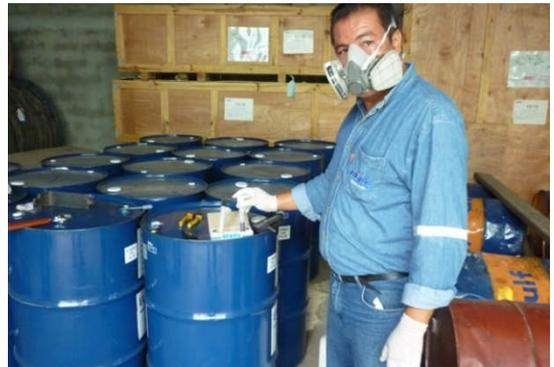
En la Subestación Pagua el 21-sep-12 se realizó una prueba aleatoria a un lote adquirido. El resultado fue (-) PCBs
