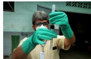
esté abierto totalmente antes de dispensar la solución clara. Descargue la solución clara en el tubo No.2 (hasta la línea de 5 ml) comprimiendo los lados del tubo. Rompa la ampolla inferior (color claro) y agite a fondo por 10 segundos, luego desenrosque ligeramente el tubo para liberar el gas. Rompa la ampolla superior (color amarilla) y agite a fondo por 10 segundos. Deje la muestra del tubo No.2 en reposo por 2 minutos con el tapón blanco como base.
