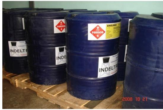
**Nro. 5:** Luego de etiquetados se almacena adecuadamente los transformadores y tanques con aceite dieléctrico usado
