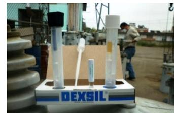
**Segundo paso.- Preparación:** Desenrosque el tapón dosificado color negro del tubo No.1. Con la pipeta plástica, transfiera exactamente 5 ml (hasta la línea marcada) de aceite dieléctrico del transformador que se
