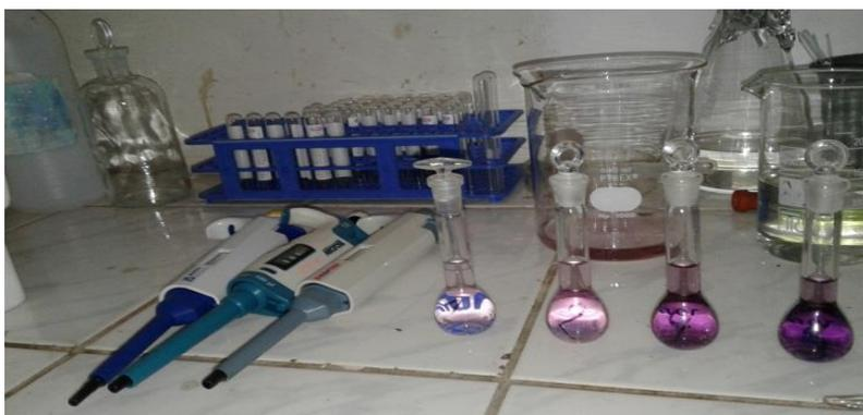
**Foto N° 3:** *Celdas del espectrofotómetro con diferentes diluciones de DPPH para calibración del equipo*
