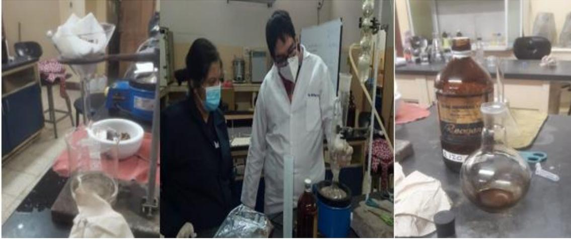
*Obtener extracto, agregar fruta seca más metanol y aplicar el método de soxhlex.*
