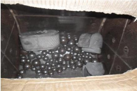
Figura 7: Molino de bolas con el catalizador antes del molido.
