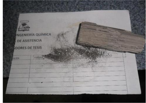
Figura 6: Hollín eliminado del catalizador por agitación
