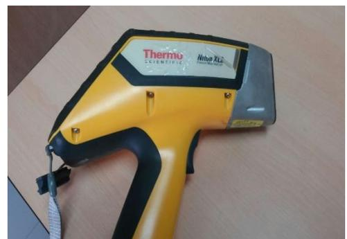
Figura 14: Analizador XRF marca Thermo Scientific modelo niton xl2
