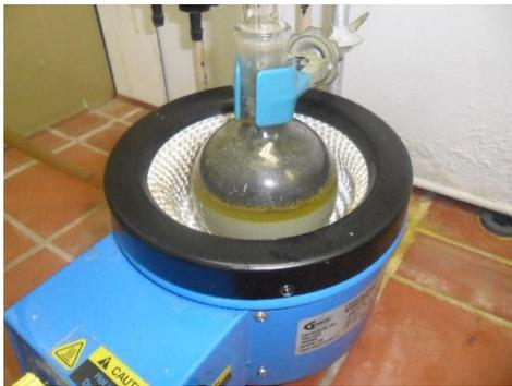
Figura 11: Inicio de la digestión ácida del catalizador (tiempo: min 0)
