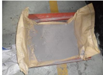
Figura 8: Catalizador después del molido.
