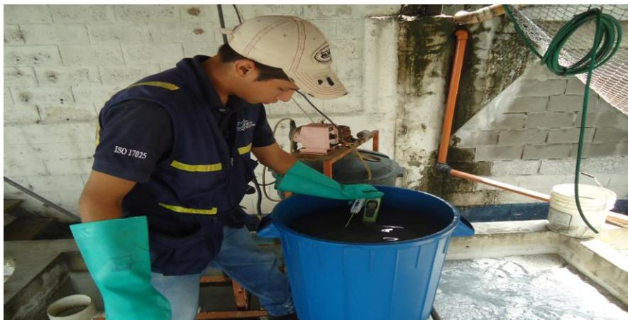
**Fotografía 4.10.-** Primer monitoreo de temperatura y PH a la salida de la Planta Piloto de Tratamiento
