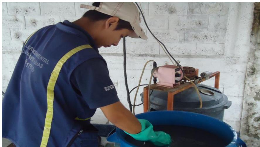
**Fotografía 4.15.-** Tercer monitoreo de temperatura y PH a la salida de la Planta Piloto de Tratamiento
