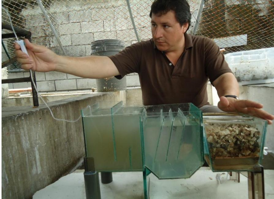
**Fotografía 4.8.- Regulación del flujo de salida**
