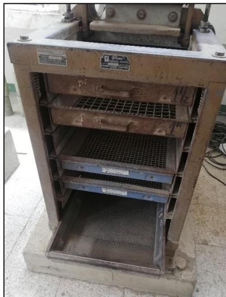
**Ilustración 9:** Máquina Vibratoria para Granulometría.
