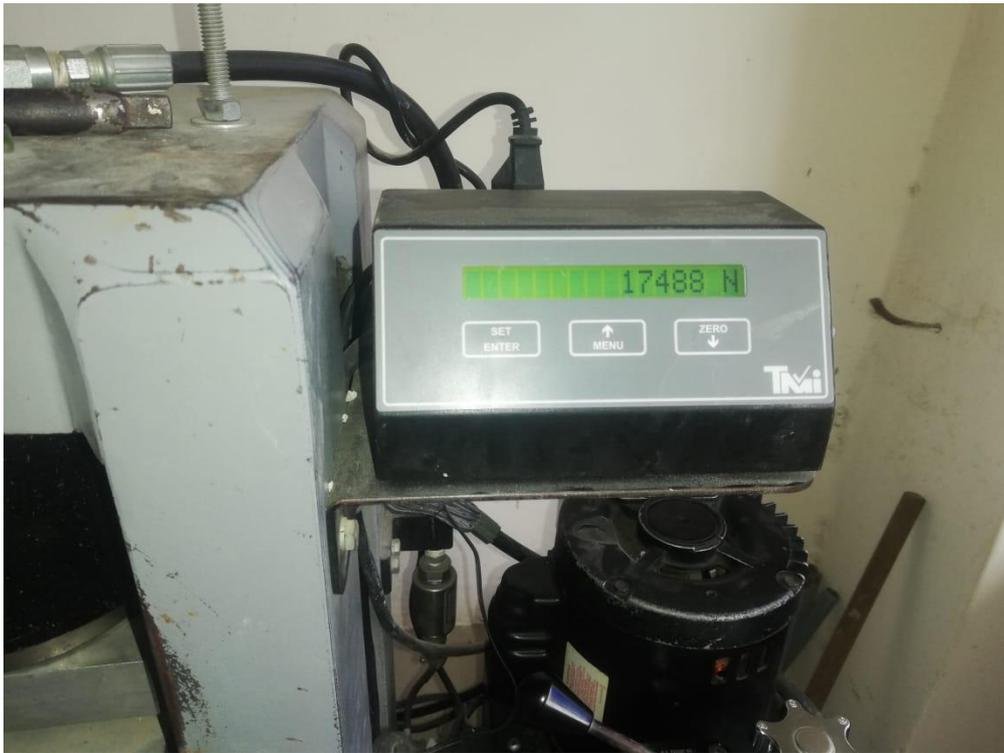
**Carga aplicada para los especímenes sometidos a la resistencia a la flexión.**
