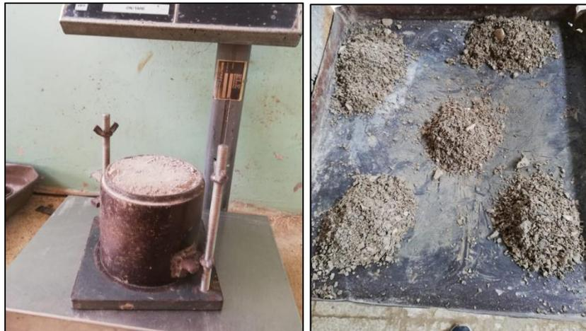
**Ilustración 15:** Desarrollo del ensayo de Proctor.
