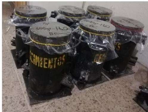
**Ilustración 28:** Muestras de bases cementadas.
