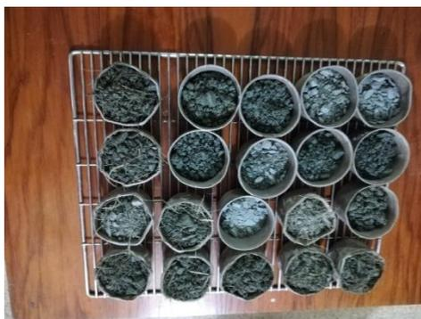
**Ilustración 17:** Muestras para determinar la Humedad tomadas en la realización del Ensayo Proctor Modificado.
