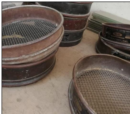
**Ilustración 8:** Tamices para realizar Granulometría.
