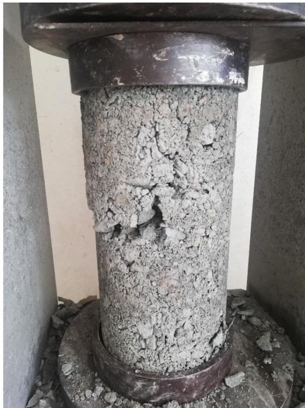
**Falla del espécimen con 3% de cemento en la rotura de 7 días.**
