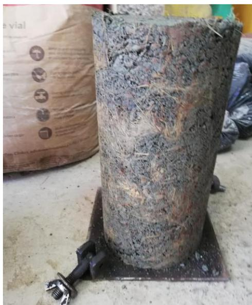
**Ilustración 29:** BAEC-F (Especimen con fibra vegetal de Abacá)
