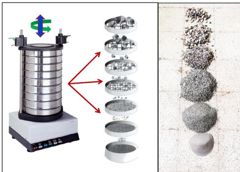
**Ilustración 7:** Composición de los agregados según los distintos tamices
