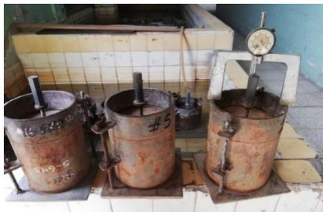
**Ilustración 18:** Medida de Expansión de la muestra.
