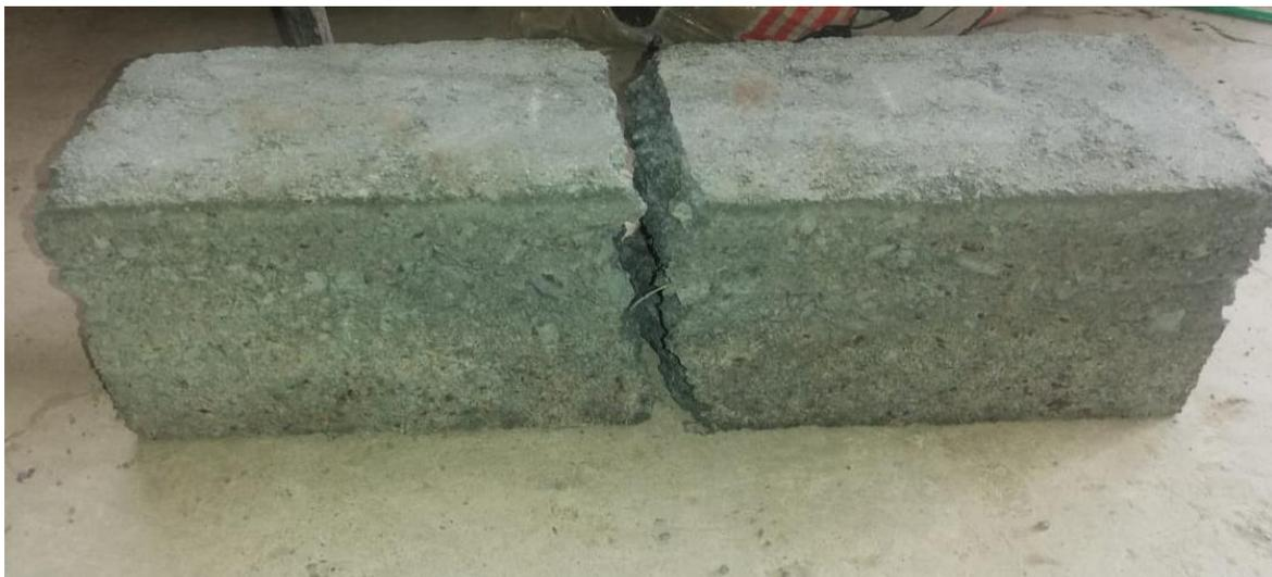
**Falla de Viga con 4% de cemento dentro del 1/3 medio.**
