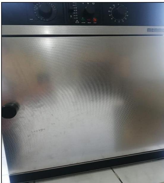
**Ilustración. 6** Estufa para el secado de las semillas Persea americana Mill variedad Hass.
