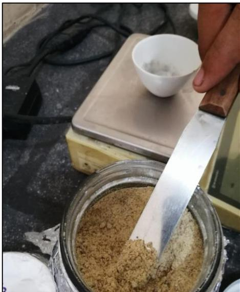
**Ilustración. 13** Pesaje de muestra para el ensayo de humedad.
