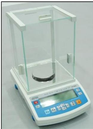
**Ilustración 6.** Balanza Analítica
