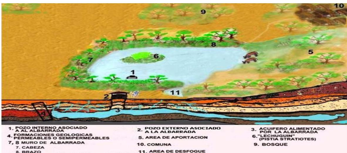
Figura 6 Elementos que conforman un sistema de Albarradas
