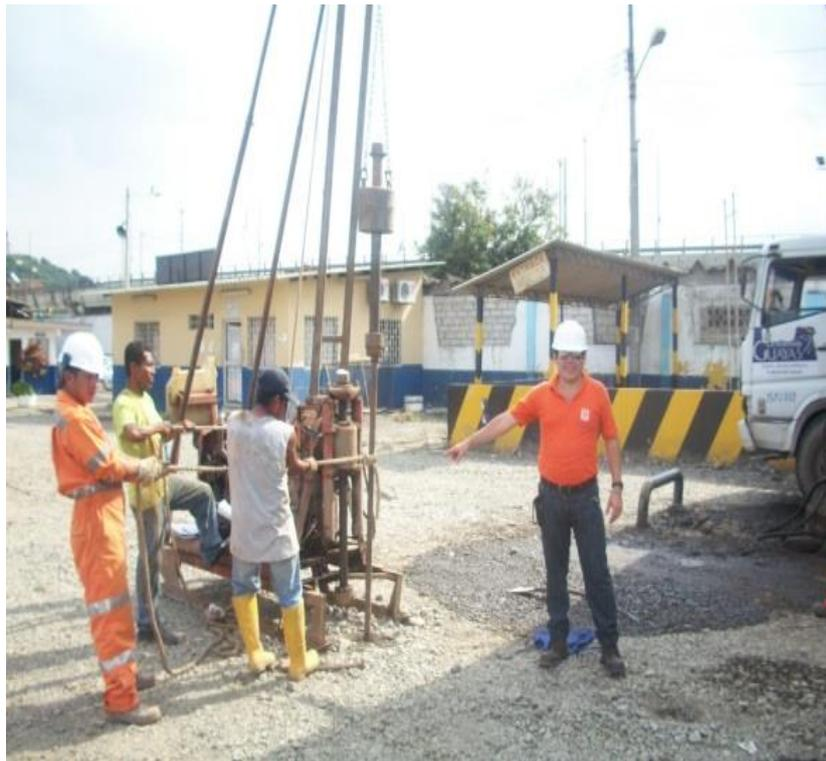
**Foto 10:** Maestrante dirigiendo los trabajos de perforación, recolección de muestras de agua y suelo subterráneas de la gasolinera Galpones del GPG 2012
