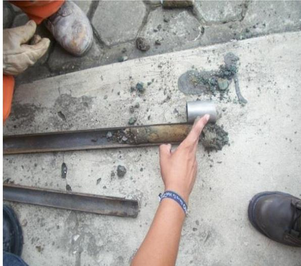
**Foto 9:** Muestreador de suelos Split Barrel con muestra de suelo para laboratorio de la gasolinera Galpones
