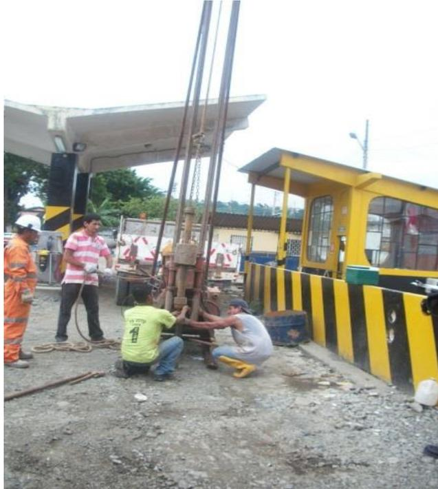
**Foto 7:** Máquina perforadora con aditamento de Split barrel en la gasolinera Galpones, realizando perforaciones
