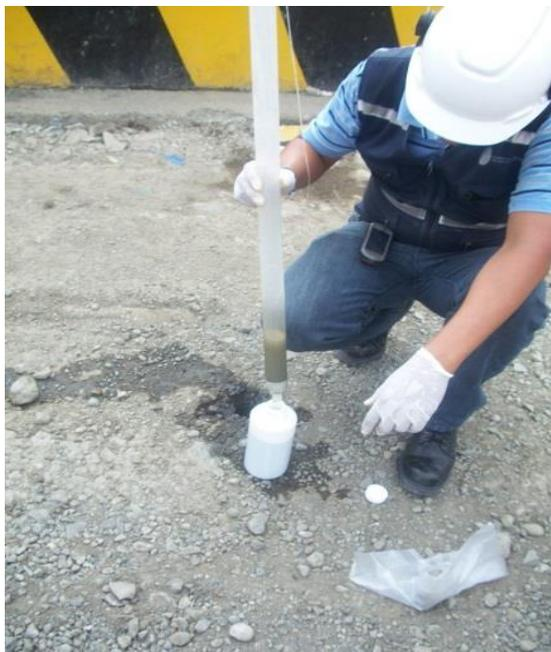
**Foto 8:** Técnico de laboratorio tomando muestra de agua del nivel freático de la gasolinera Galpones
