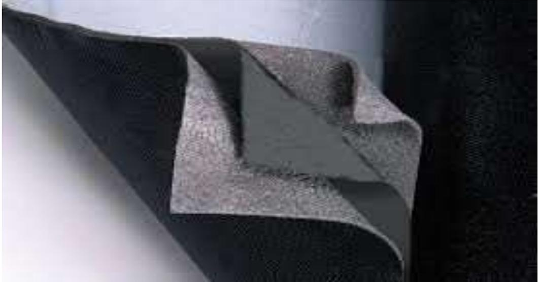
*Figura 12. Material masivo de plomo*
