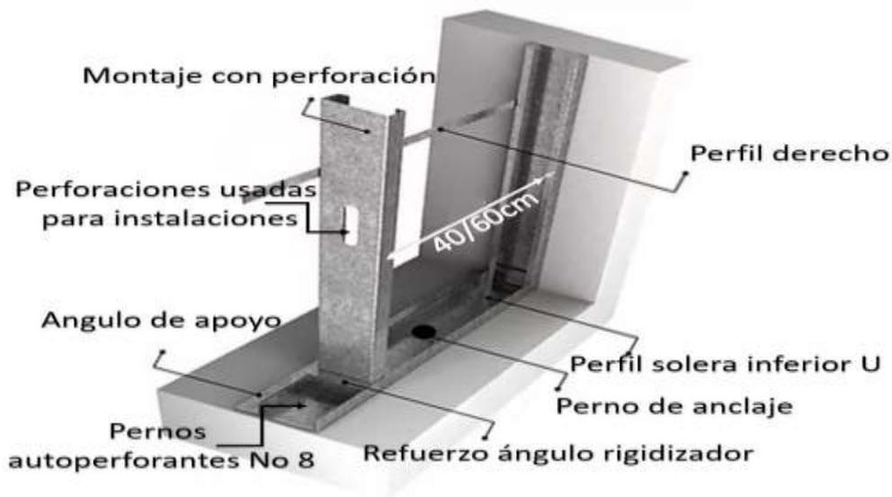
*Figura 8. Tipo de ensamblaje de perfiles galvanizados*
