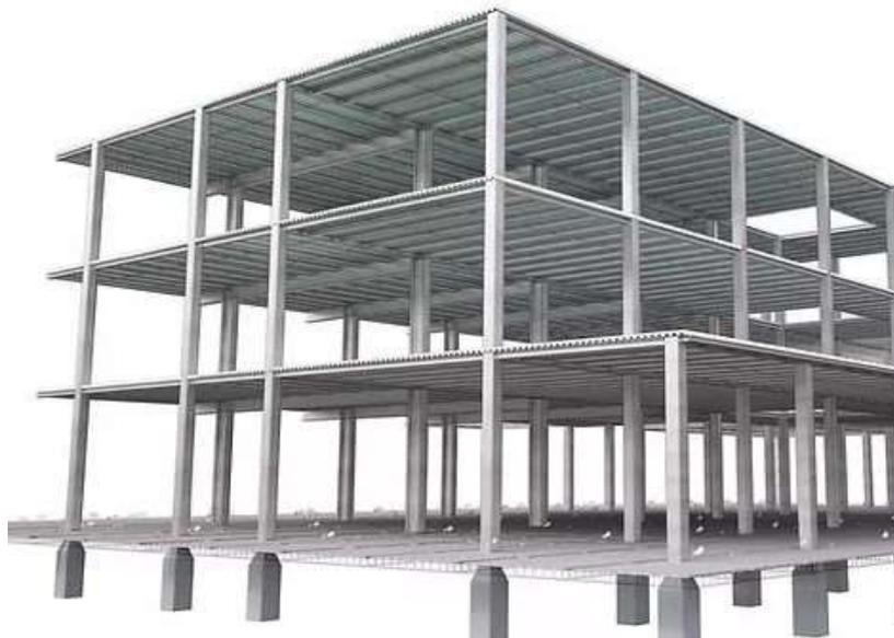
*Figura 69 modelo de edificio con estructura metálica
