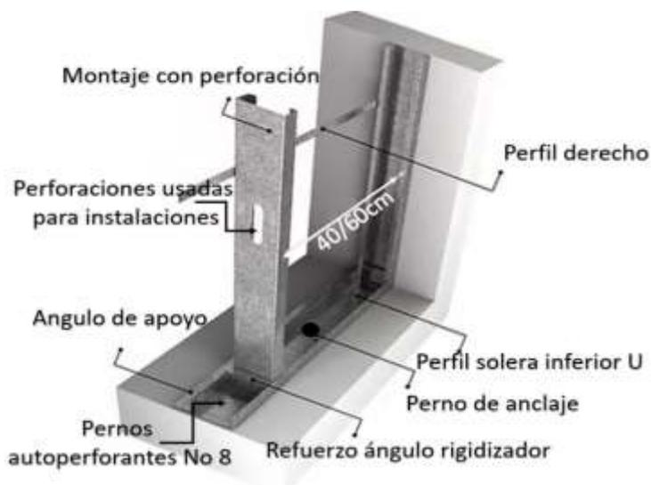
Figura 75: Detalle de paredes móviles
