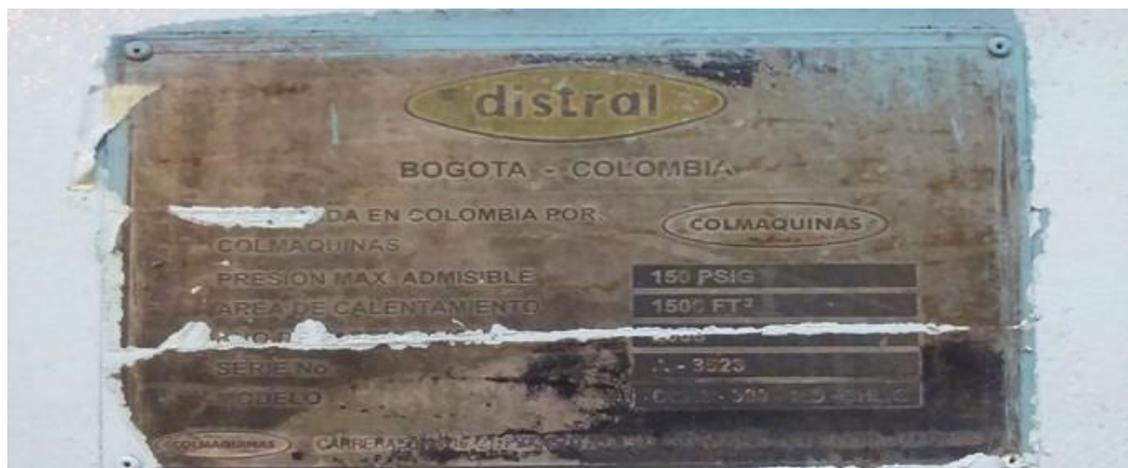
**Figura 4.** Placa de identificación de la caldera. Información tomada de investigación de campo. Elaborado por el autor.
