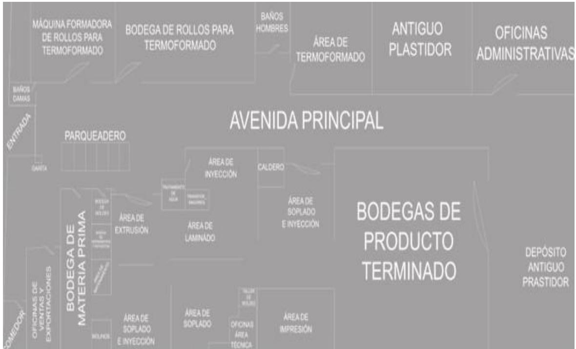
**Figura 7.** Distribución de la planta Plásticos Ecuatorianos S.A. Información tomada de Castillo, (2008). Elaborado por el autor.
