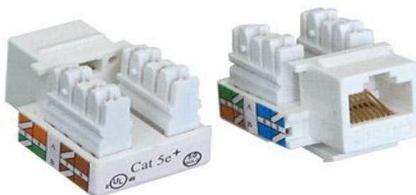
El cable debe pasar por el centro del conector como se muestra en la figura, entre las dos ranuras de color "beige", y los hilos los iremos colocando en cada una de las ranuras. Observamos que tenemos 8 ranuras, 4 a cada lado.
