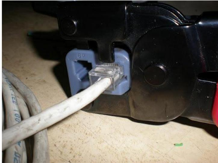
Una vez tenemos el cable punchado, este se conectará por un extremo en el conector de la tarjeta de red del host, y por el otro generalmente en la toma Jack RJ-45 hembra situado en la pared, que será la que nos dé acceso a la red.
