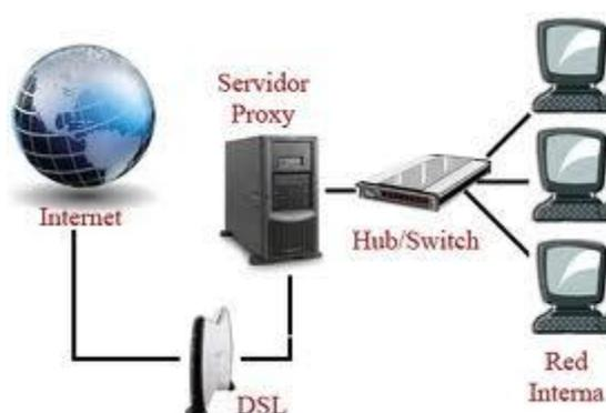
Ilustración 2: Esquema de un servidor proxy
