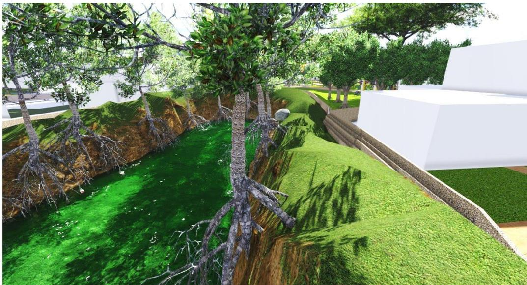
Las viviendas que queden expuestas a la construcción de la red de manglares, se las reforzará con un muro de contención, hecho de piedra pómez y que llegará a una altura de 1,20m desde la cota de acera del sector.
