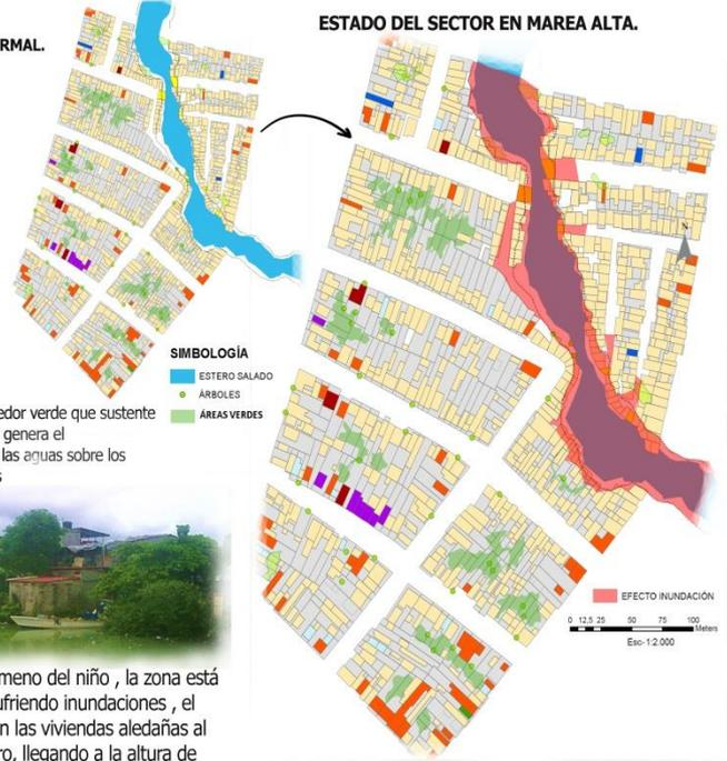
La falta de un corredor verde que sustente el cauce del Estero genera el derramamiento de las aguas sobre los terrenos rellenados
