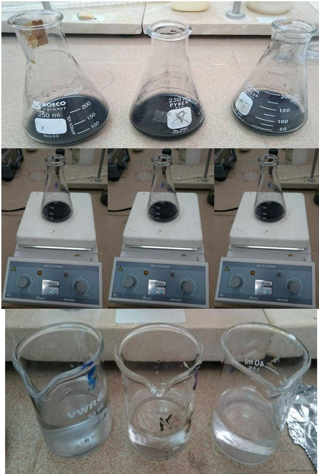
**Figura 11.** Prueba de adsorción de 6 horas al carbón activado obtenido: carbón activado de cacao, carbón activado de coco y carbón activado comercial respectivamente.
