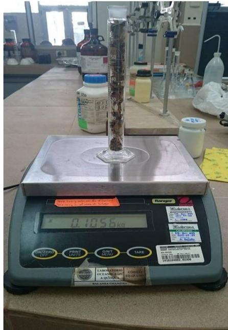
**Figura 9.** Prueba de densidad aparente a la materia prima.
