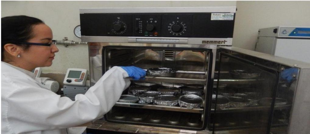
**Figura.4** Deshidratación del carbón en la mufla
