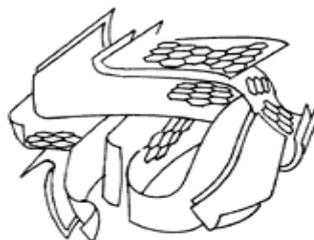
**Figura II.** Representación esquemática de la estructura de un carbón activado
