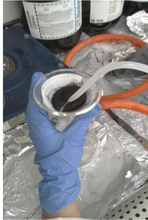
**Figura.6.** Lavado del carbón con agua destilada
