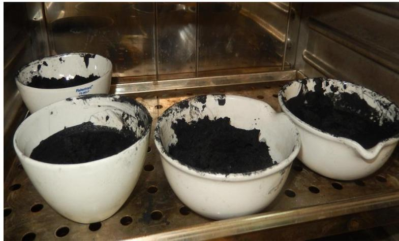
**Figura 7.** Secado de las muestras del carbón al horno
