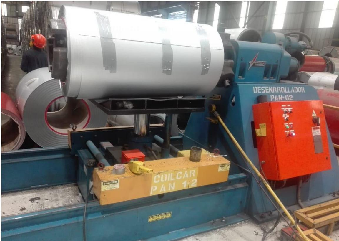
**Figura 3.** Colocación de bobina metálica en desbobinador. Información tomada de la empresa de estudio. Elaborado por el autor
