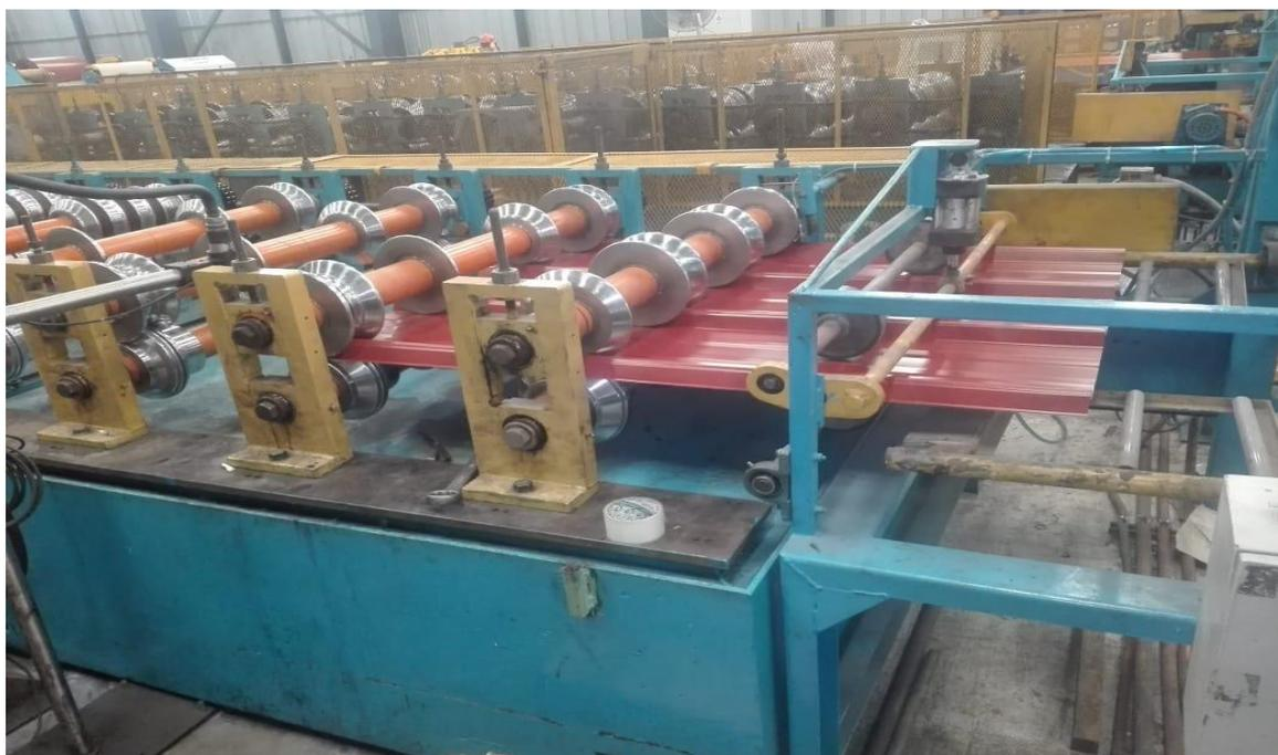
**Figura 6.** Conformado de la cubierta metálica. Información tomada de la empresa de estudio. Elaborado por el autor
