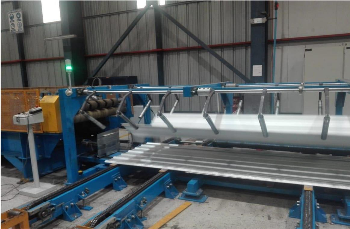
**Figura 8.** Conteo de cubierta metálica en Apiladora. Información tomada de la empresa de estudio. Elaborado por el autor
