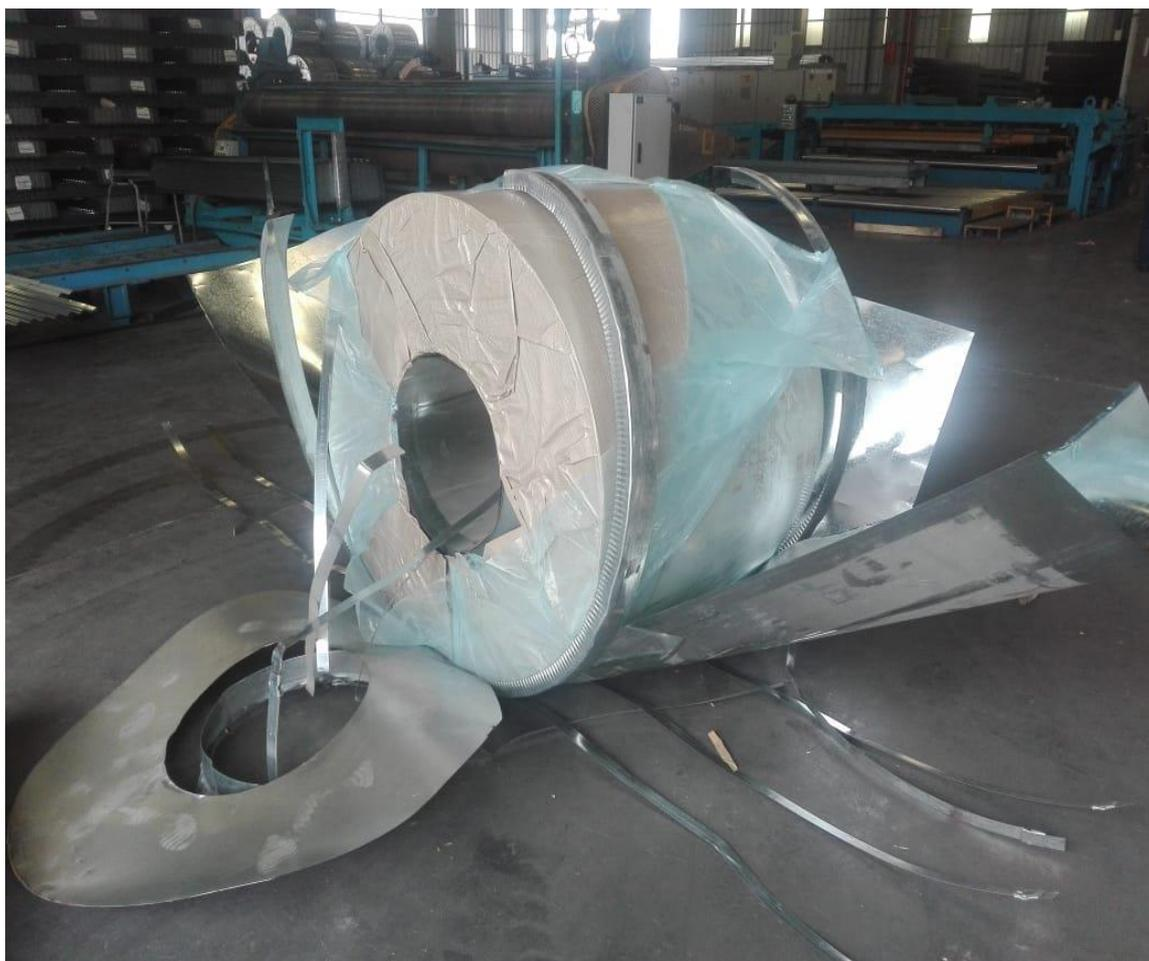
*Figura 1. Pelado de bobina metálica. Información tomada de la empresa de estudio. Elaborado por el autor*
