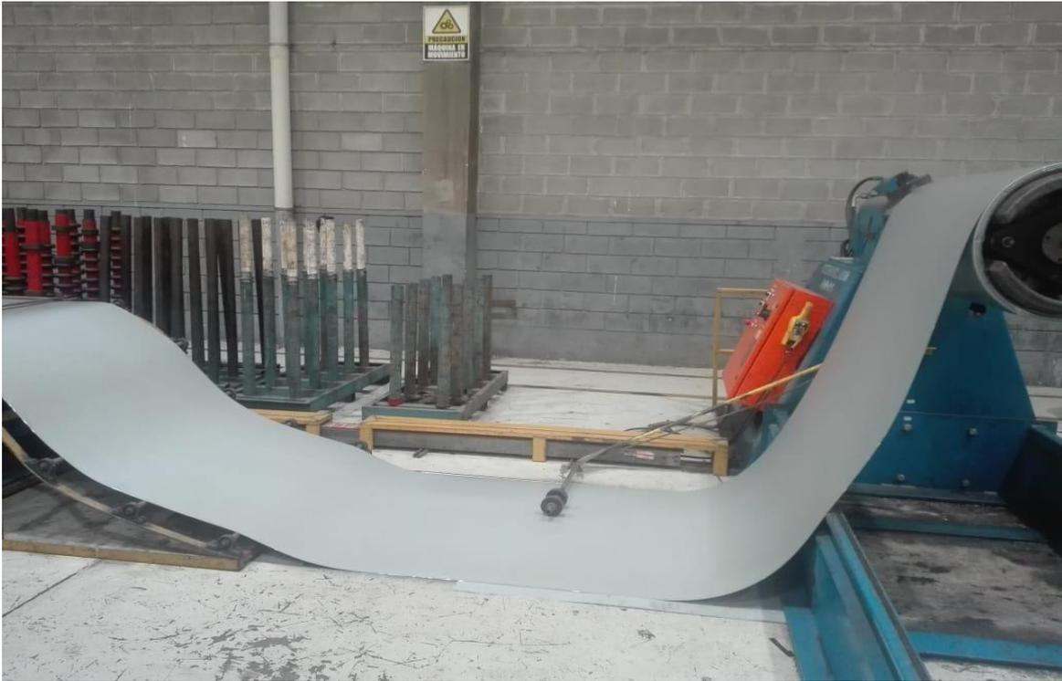
**Figura 4.** Desenrolle de bobina metálica para corte. Información tomada de la empresa de estudio. Elaborado por el autor
