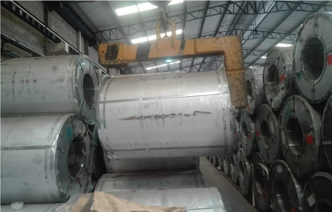
**Figura 2.** Traslado de bobina metálica en puente grúa. Información tomada de la empresa de estudio. Elaborado por el autor
