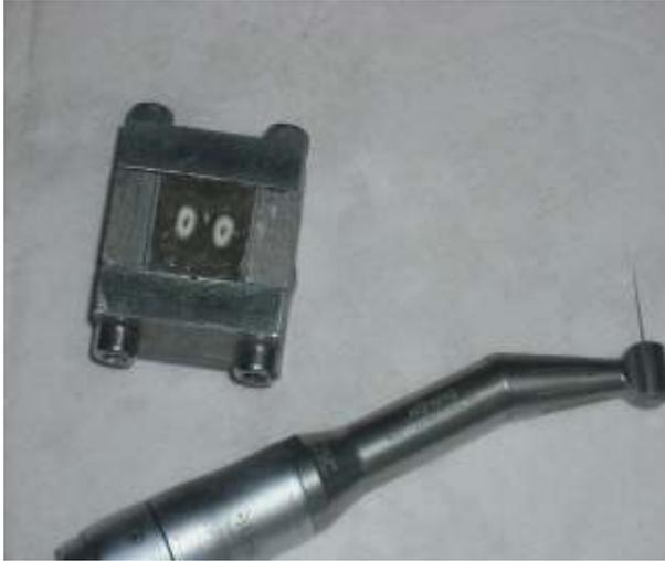
**Foto 6** Preparación de las muestras con el sistema oscilatorio y sistema rotatorio.
