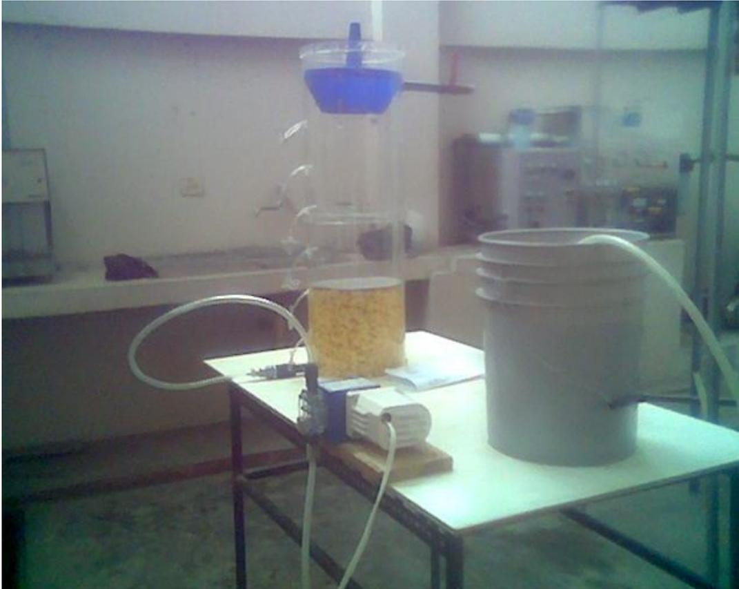
En esta imagen podemos observar, el reactor armado, el cual consta de: cuerpo cilíndrico, una campana para evitar la salida del lodo por el efluente, consta de un relleno a base de anillos plásticos, de unas mangueras a diferentes nivel de altura; para poder tomar muestras, una bomba dosificadora y un balde de alimentación.
