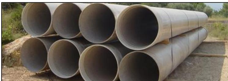
**Ilustración 13:** Tubería de poliéster reforzado.
