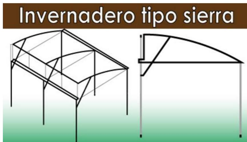
**Ilustración 23:** Estructura de un Invernadero tipo sierra
