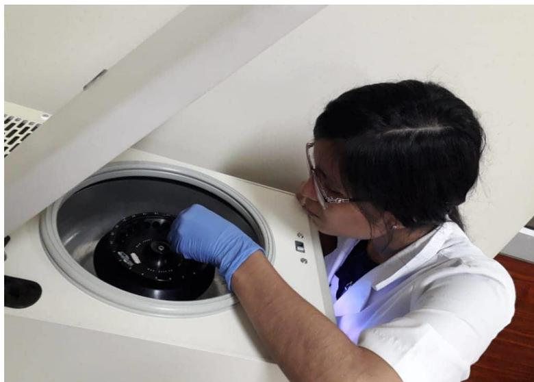
**Anexo 2.** Centrifugación del sobrenadante con acetato de amonio 5M en el proceso de extracción de ADN.
