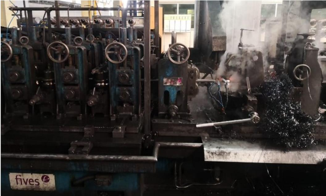
**Figura 26.** Sistema de Desbarbado Tubera. Tomada de Novacero Galpón Conformado.
