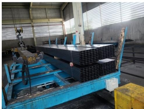
**Figura 22.** Carro de Evacuación Perfiladora. Tomada de Novacero Galpón Conformado.
