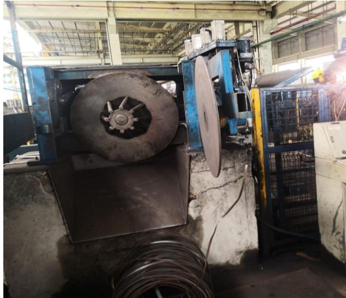
**Figura 15.** *Rebordera de Slitter. Tomada de Novacero galpón Conformado.*
