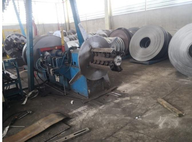
*Figura 18. Desbobinador De Perfiladora. Tomada de Novacero Galpón Conformado.*
