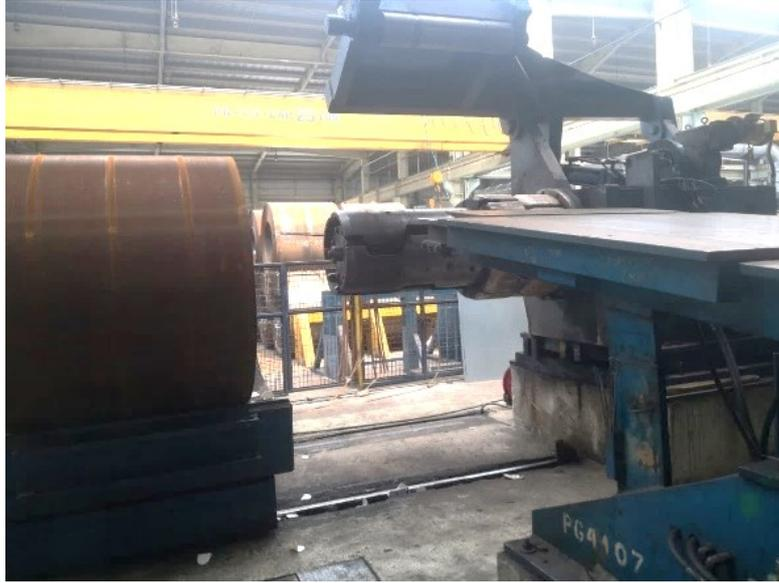
**Figura 13.** Desbobinador Slitter. Tomada de Novacero Galpón Conformado.
