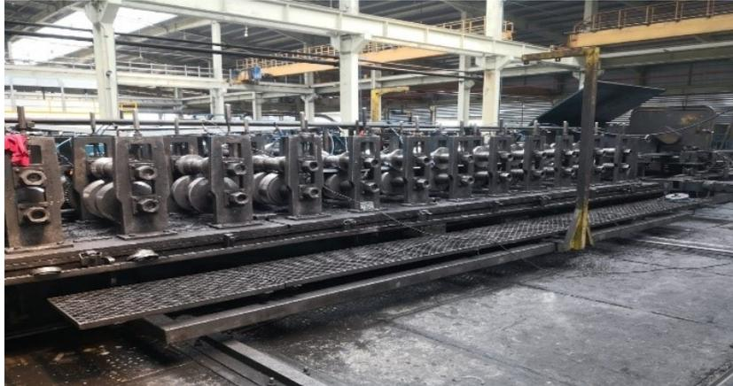
**Figura 20.** Forming Perfiladora. Tomada de Novacero Galpón Conformado.
