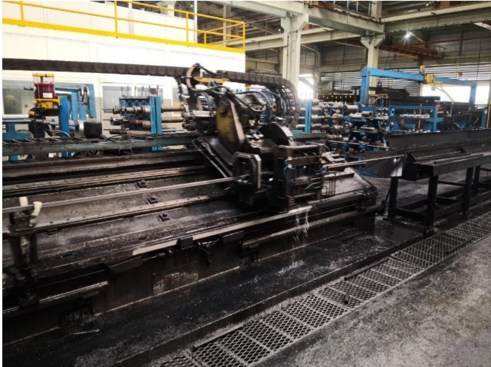
**Figura 28.** Sistema de corte Tubera. Tomada de Novacero Galpón Conformado.
