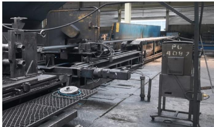
**Figura 21.** Sistema de Corte Perfiladora. Tomada de Novacero Galpón Conformado.
