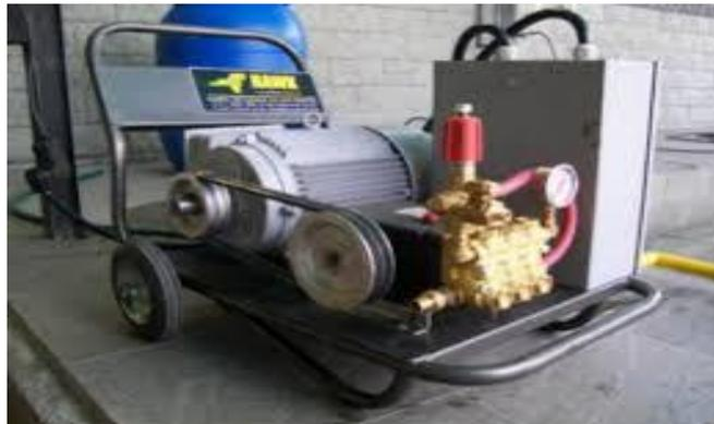
**Figura 29.** Bomba de agua a presión
