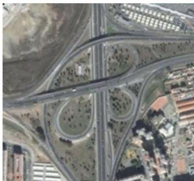
*Ilustración 8 Trébol modificado con un ramal sin lazo*
