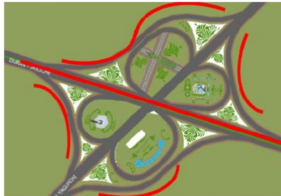
*Ilustración 60.* Ejemplificación con líneas rojas de la distribución de la iluminación vial en el distribuidor.
