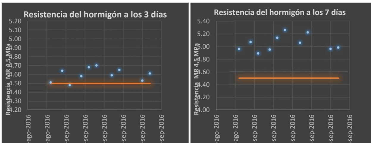
**Ilustración 27:** Grafica de resistencia a la flexión de vigas de hormigón MR 4,5 MPa a los 3-7 días
