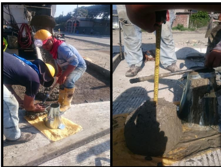
**Ilustración 25:** Prueba de asentamiento del hormigón.
