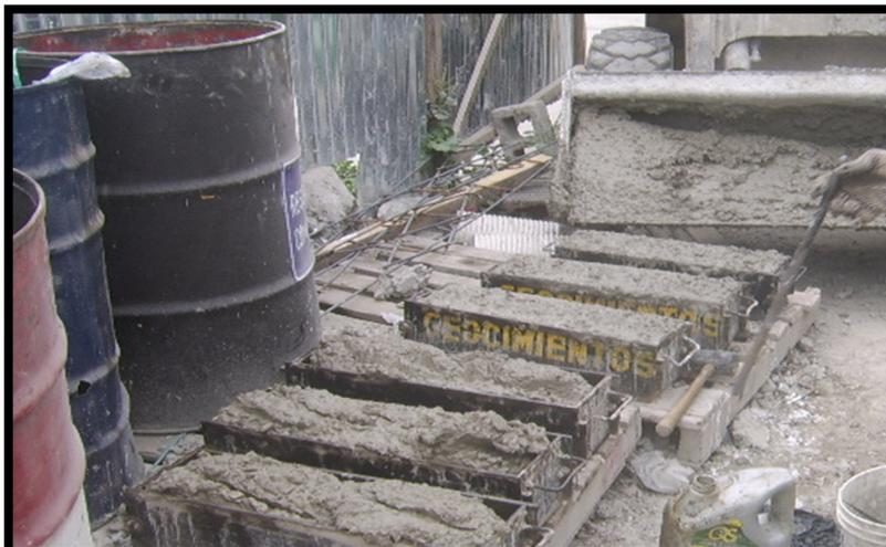
**Ilustración 26:** Toma de muestras de hormigón para vigas.
