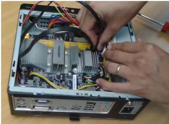
Paso 5. Colocación del Disco Duro: El dispositivo de almacenamiento de datos se coloca por la parte interna del gabinete, dentro de la bahía respectiva. Se hace coincidir los orificios y se fija con los tornillos correspondientes, finalmente se colocan los cables de datos SATA y de energía. De modo opcional podemos colocar la unidad Óptica de la misma manera que se instaló el disco duro.
