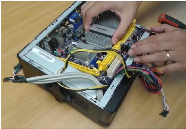
Paso 3. Instalación de la memoria RAM: Se insertan en los bancos de memoria RAM y se fijan con los seguros laterales. El número de ranuras puede variar según el fabricante y el modelo de la tarjeta principal. En este caso, la tarjeta tiene dos ranuras y se está insertando solo un DIMM de 4 GB MB.
