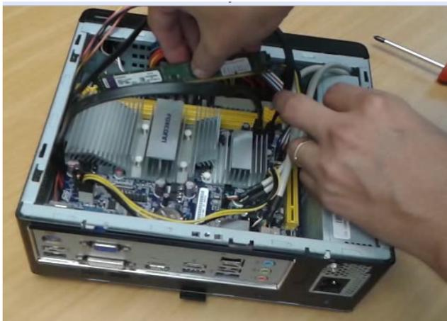
Paso 4. Conexión de cables a la placa madre. Conectamos los cables de energía de la Placa Madre y procesador, además de los conectores USB Frontal y de sonido Frontal(altavoz y micrófono). Luego conectaremos la alimentación de los leds de la frontal:
