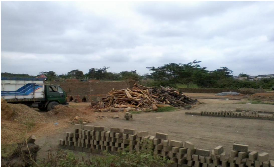
**Figura # 4: Uso de madera remanente como combustible en la cocción de ladrillos**
