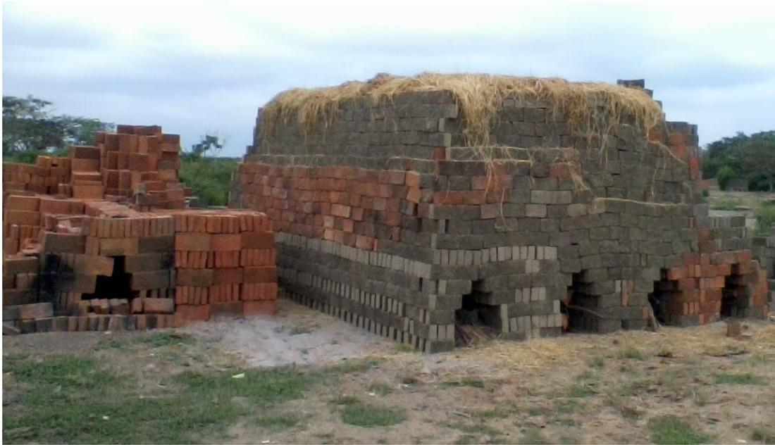
**Figura # 22: Secado de ladrillos a manera de horno**
