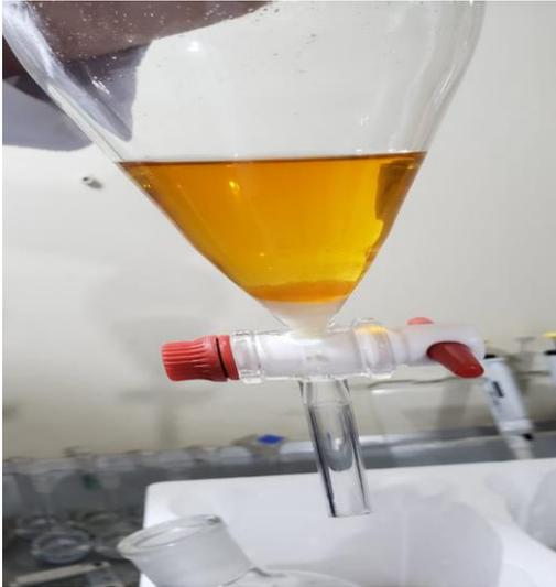
**Anexos L** Extracción de la muestra en el análisis de la cromatografía
