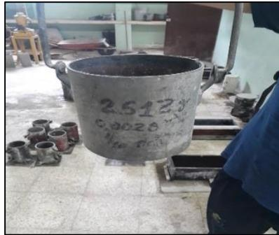
**Ilustración 6:** Balde Metálico para realizar el Ensayo de Peso Volumétrico Suelto
