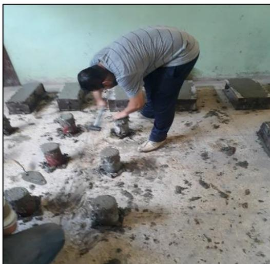
**Ilustración 11:** Compactación de cilindros con varilla
