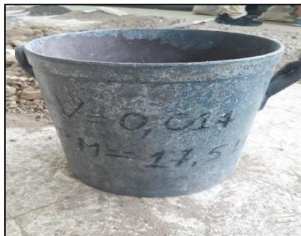
**Ilustración 7:** Balde Metálico para realizar el Ensayo de Peso Volumétrico Varillado
