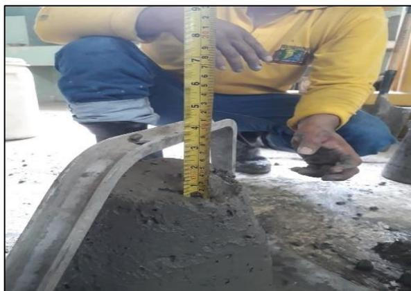
**Ilustración 10:** Medición de revenimiento
