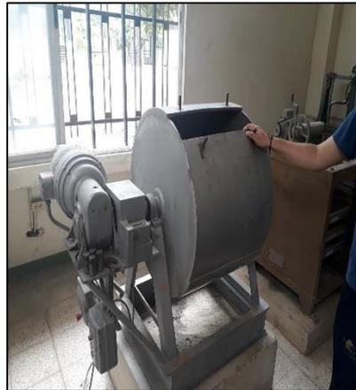
**Ilustración 8:** Ensayo de abrasión de los ángeles
