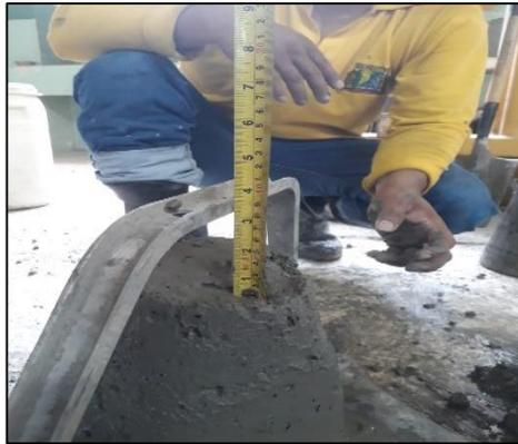
**Ilustración 1:** Ensayo de Revenimiento
