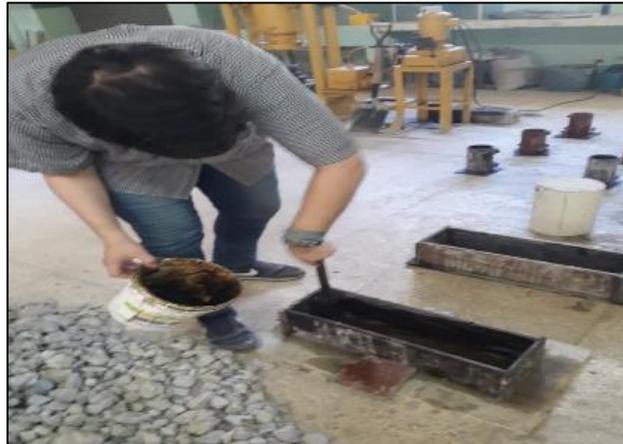
**Ilustración 14:** Compactación de vigas con varilla
