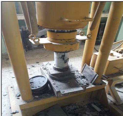
Ensayo de Resistencia a la Compresión
