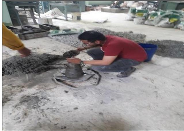
**Ilustración 9:** Prueba de revenimiento
