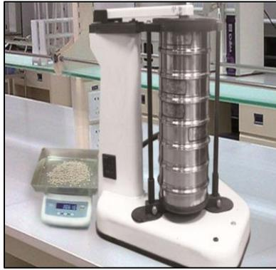
**Ilustración 3:** Ensayo Granulométrico de Agregado Fino
