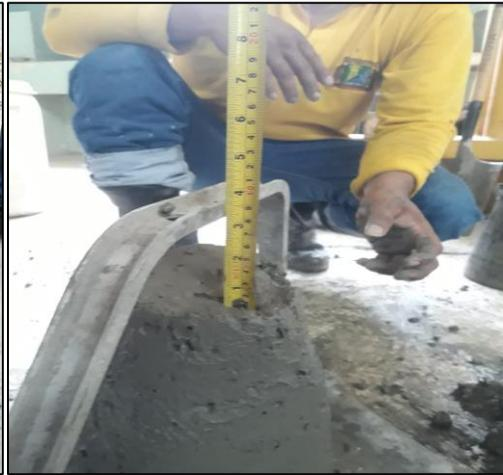
Ensayo de Revenimiento del Hormigón
