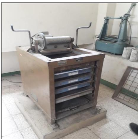
**Ilustración 2:** Ensayo Granulométrico de Agregado Grueso
