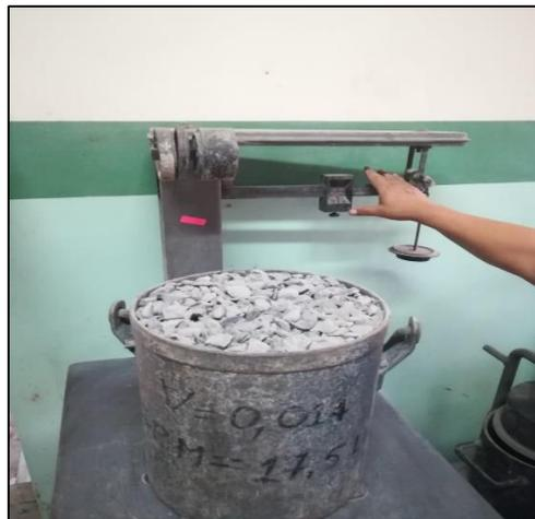
Ensayo de Peso Volumétrico Varillado
