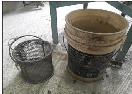
**Ilustración 5:** Equipo a utilizar para Ensayo de Densidad y Absorción para Agregado Grueso
