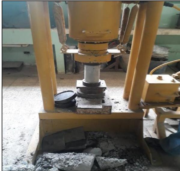
**Ilustración 13:** Ensayo de resistencia a la Compresión del Concreto
