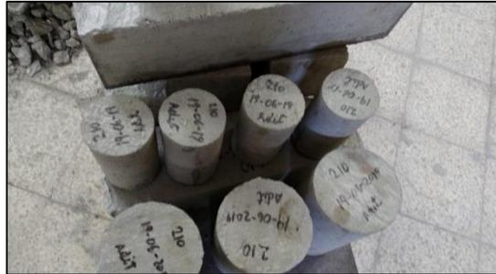
**Ilustración 12:** Colocación de la fecha de elaboración en los cilindros de concreto
