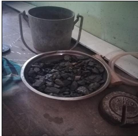
Ensayo de Peso Volumétrico Suelto
