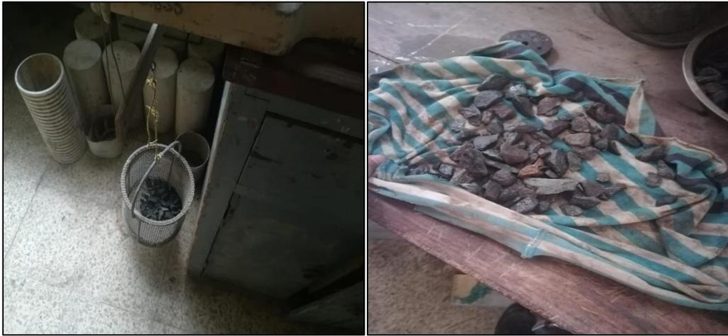
Ensayo de Densidad y Absorción de Agregados Gruesos
