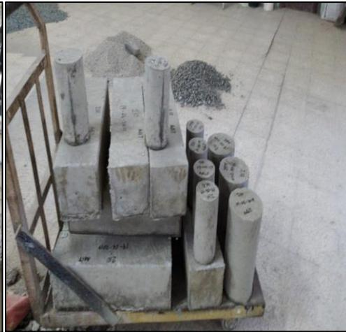
Probeta y Viguetas para Ensayar
