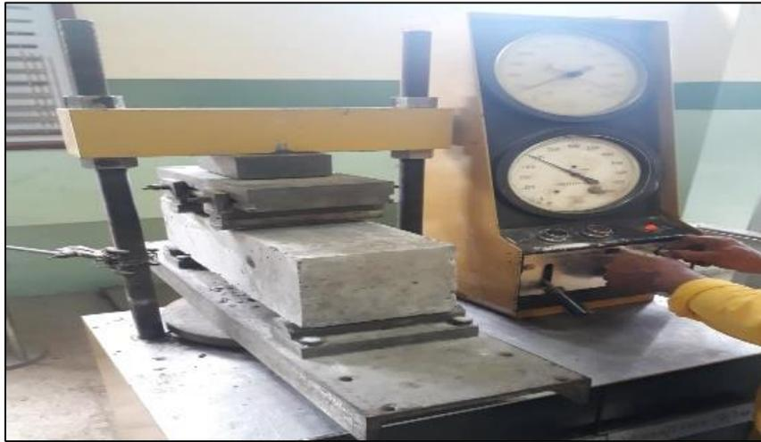
**Ilustración 15:** Ensayo de Resistencia a Flexión
