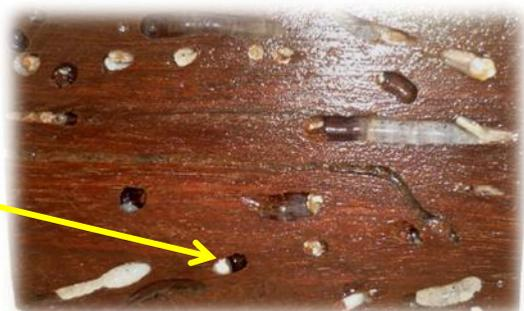
Foto 13. Maderas *Pinus sp.* (izquierda) y *Tabebuia sp.* (derecha) con mayor infestación de bivalvos perforadores, expuestas durante 2 meses
