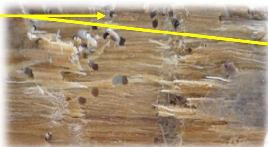
Foto 27. Madera *Alseis sp.* con el mayor grado de infestación por los bivalvos perforadores, expuesta durante 2 meses
