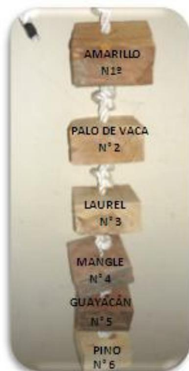
Foto 1. Colector de bloques de madera con secuencia numérica, unidos por cabo de nylon
