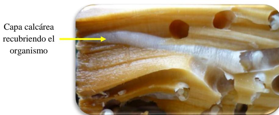
Foto 11. Molusco bivalvo perforador recubierto de capa calcárea dentro de la madera *Pinus sp.* expuesta durante dos meses
