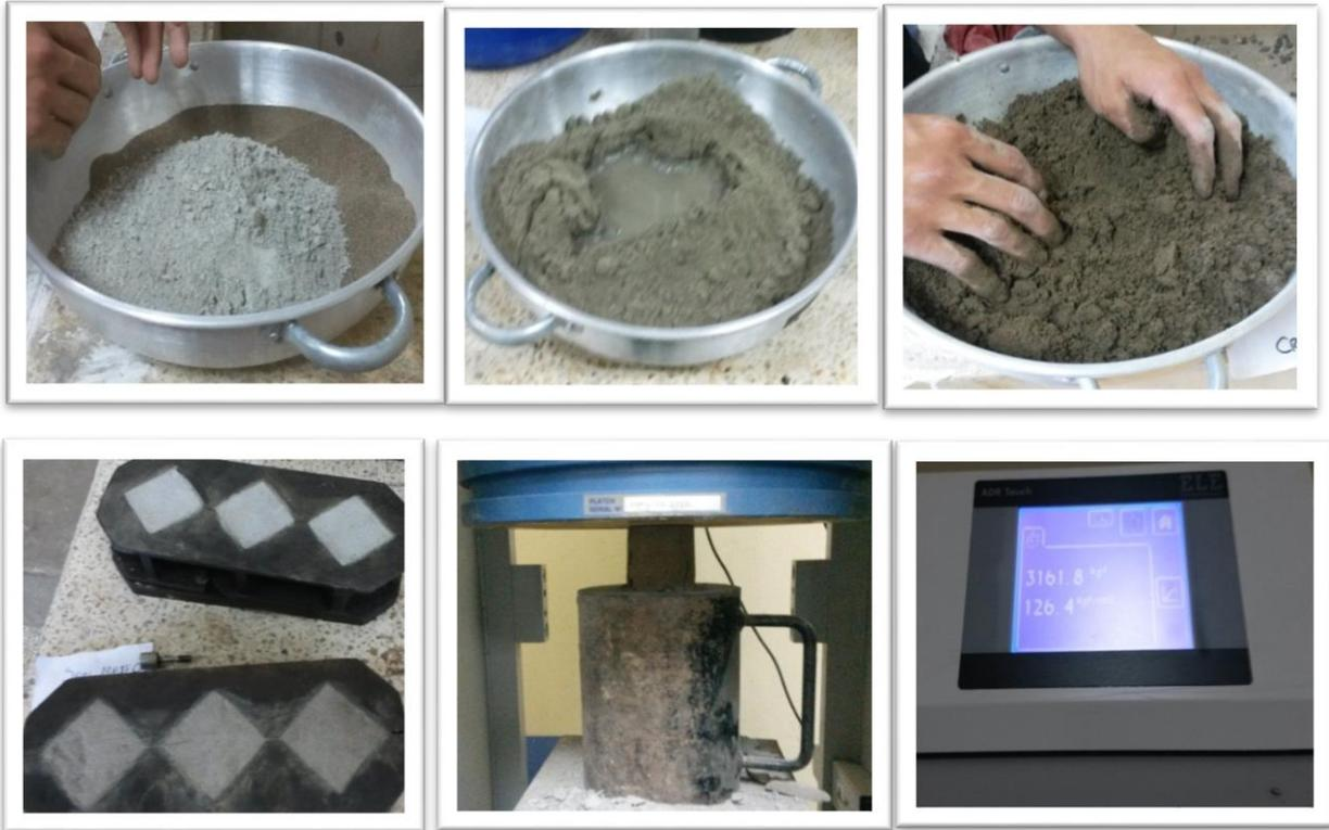
***Ilustración 19: Proceso. Prueba de resistencia a la compresión en mortero de pega.***
