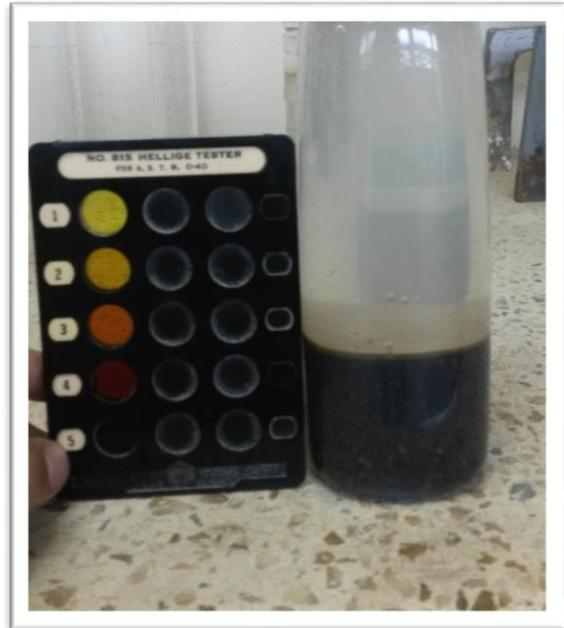
*Ilustración 15: Ensayo Impureza orgánica Río Toachi.*
