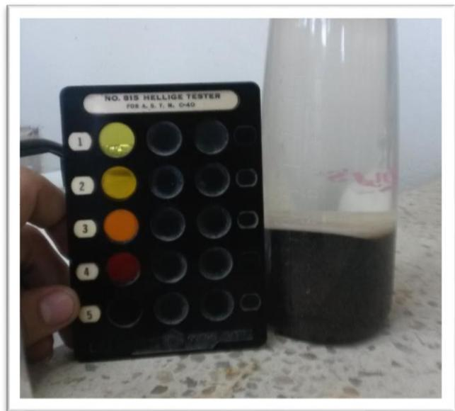
*Ilustración 17: Ensayo Impureza orgánica Río Chancay.*
