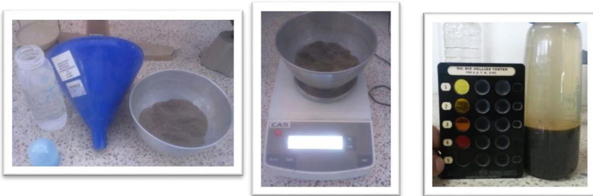
*Ilustración 11: Ensayo de Impurezas orgánicas*
