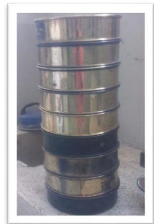
*Ilustración 3: Proceso de obtención de la granulometría de las arenas.*
