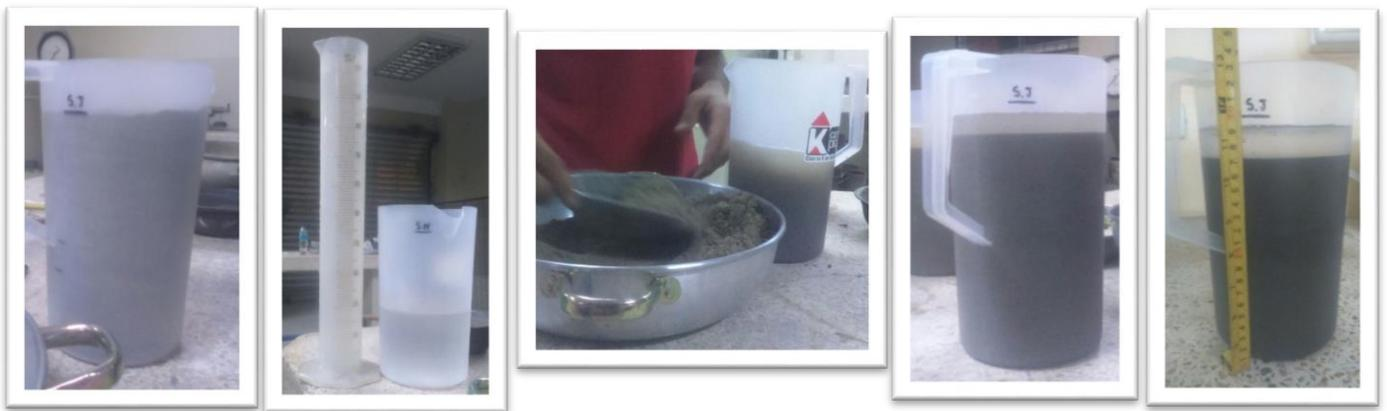
*Ilustración 18: Proceso. Prueba de hinchamiento de la arena.*
