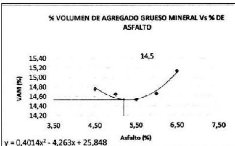
**Ilustración 34:** % de Volumen de agregado grueso mineral vs % de Asfalto mezcla agregando PETS.
