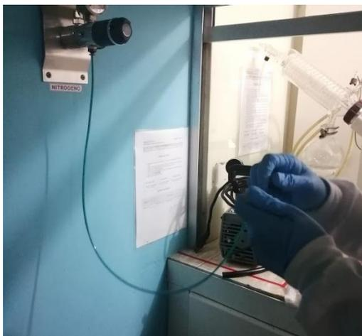
**Figura 14: Adición de Nitrógeno para insertar una atmosfera inerte en el tubo de ensayo para determinación de aminoácidos.**
