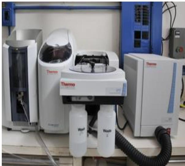
**Ilustración 10: Espectrofotómetro de absorción atómica modelo Thermo.**
