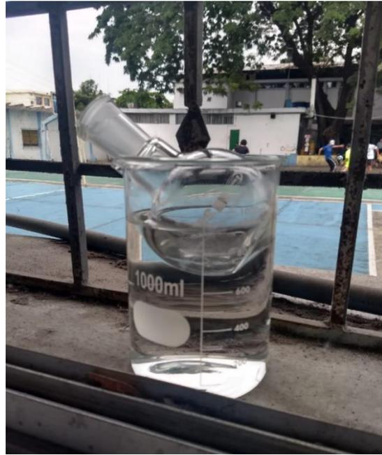
**Ilustración 8: Etapa de evaporación del éter de petróleo en la determinación de grasas.**
