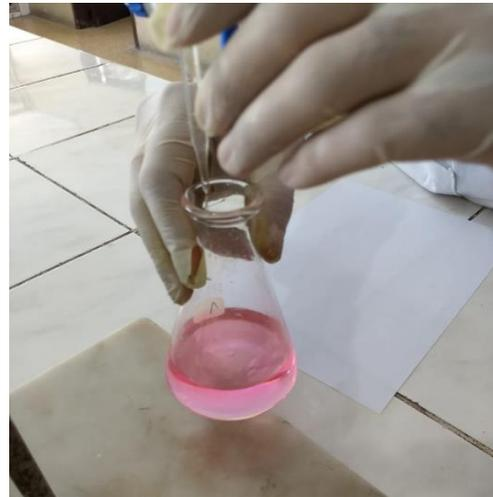
**Ilustración 6: Fase de titulación en la determinación de proteínas.**
