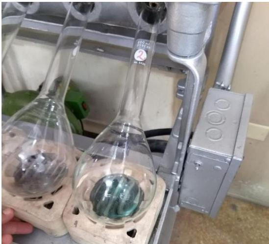
**Ilustración 5: Fase de combustión en la determinación de proteínas.**
