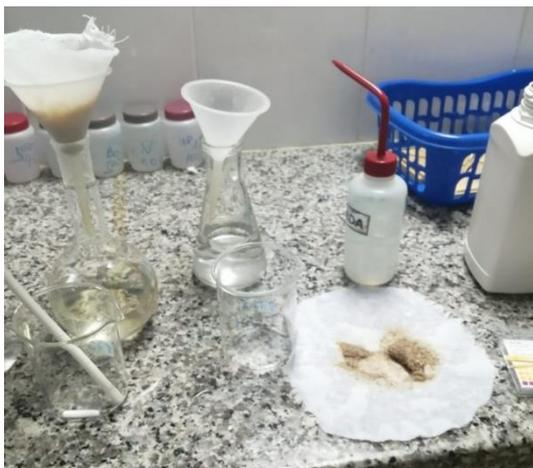
**Ilustración 11: Filtración de la muestra de hongo shiitake para la determinación de fibra.**
