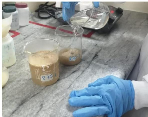
**Ilustración 12: Muestras de hongo shiitake con Hidróxido de Sodio para determinación de fibra.**
