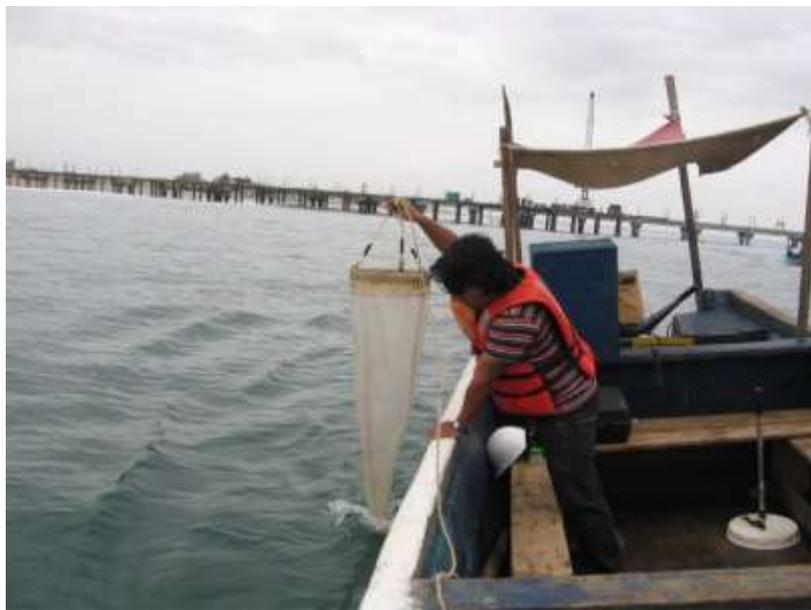
**Figura 32:** Culminación de todos los muestreos se procede a retirar la malla de 50 micras y transportar todas las muestras colectadas al laboratorio para su análisis.
