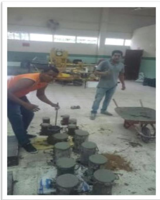
Fotografía 12: Elaboración de cilindros con Dramix
