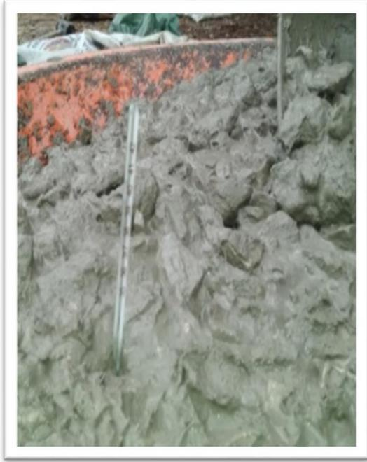
Fotografía 6: Temperatura de la mezcla
