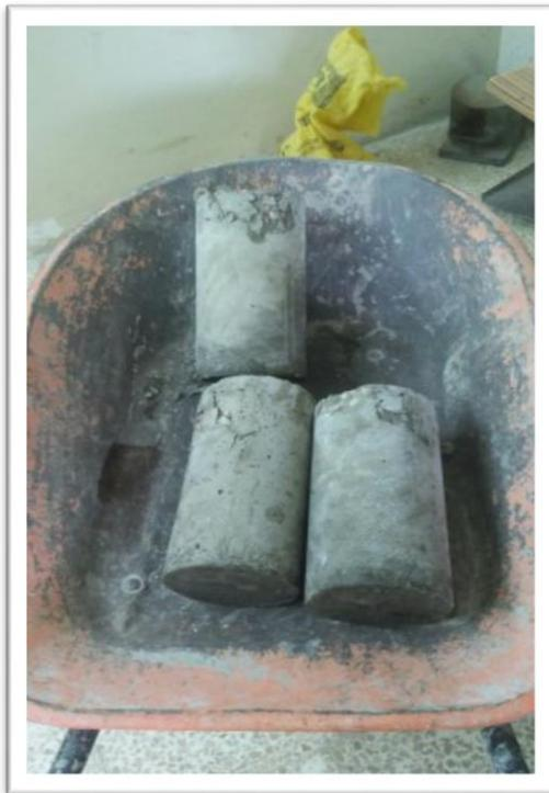
Fotografía 16: Cilindros ensayados
