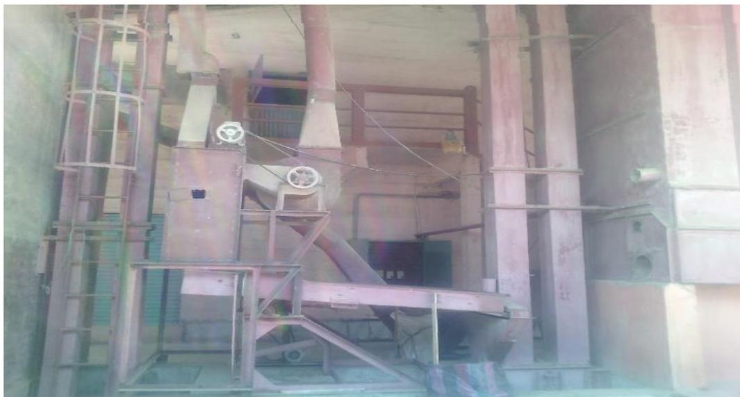
11. Elevador de cangilones para la materia prima para el proceso del pilado tomada en la piladora Salitreña y elaborada x el autor
