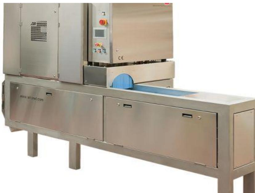
**Anexo 7.** *Máquinas corte brócoli, La máquina Silex es la primera cortadora de brócoli con corte inteligente; corta los floretes y los separa del tallo dejándolos en lugares diferentes.*
