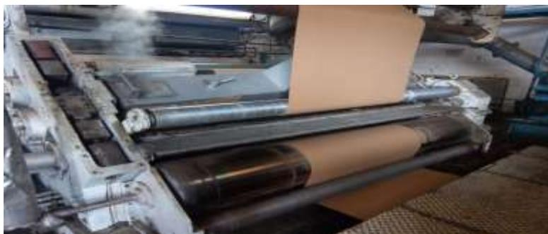
**Figura 13.** Formado de papel ondulado en la flauta de la corrugadora. Información tomada de la empresa. Elaborada por el autor.
