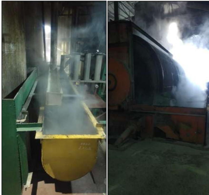
Figura 19. Encalamiento y tamiz rotativo.
