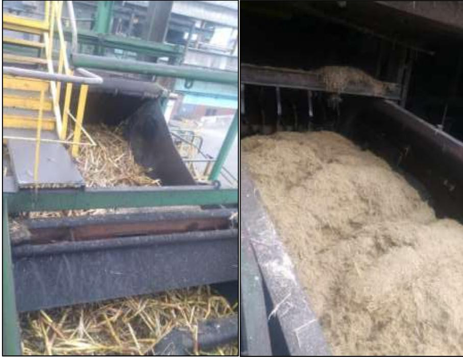
Figura 14. Entrada (izquierda) y salida (derecha) de machetes cortadores.
