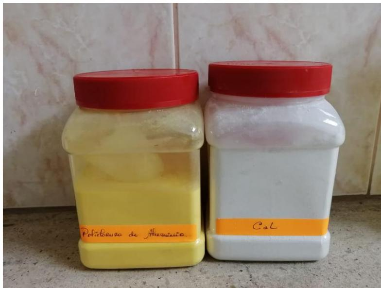
Policloruro de aluminio y cal, reactivos requeridos para la sedimentación de los lodos.
