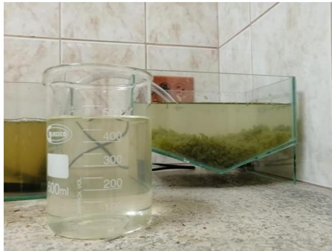
Agua clarificada luego del proceso de degradación y precipitación
