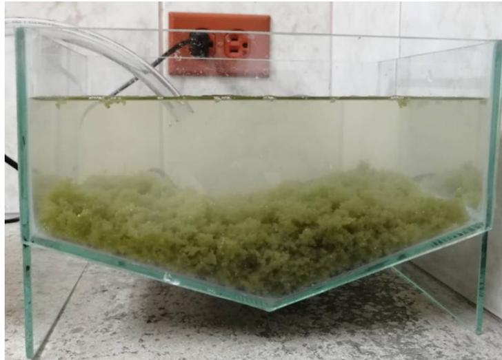
**Ilustración 17:** Tratamiento Terciario - Sedimentador
