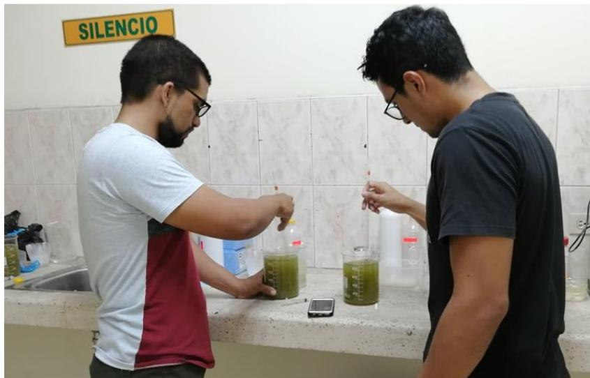
**Ilustración 16:** Realizando la prueba de jarra
