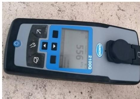
**Ilustración 18.** Equipo Turbidímetro 2100Q Marca Hach
