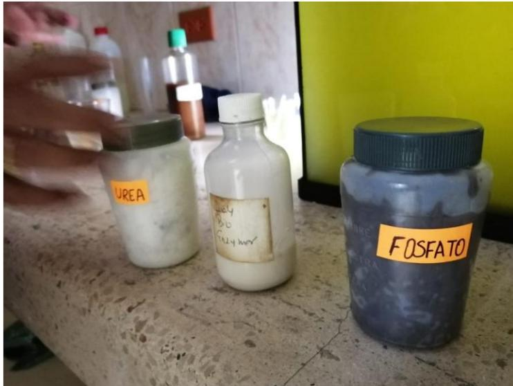
Urea, bioenzimar y fosfato que sirven para mantener bacterias en el agua
