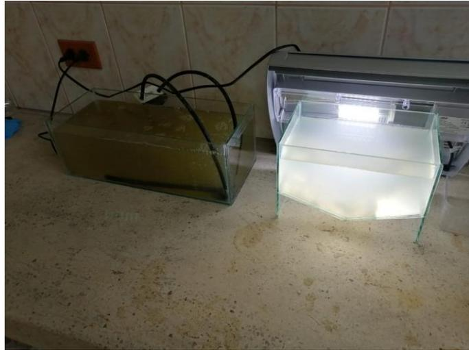
Luz detrás del sedimentador para poder observar la clarificación del agua
