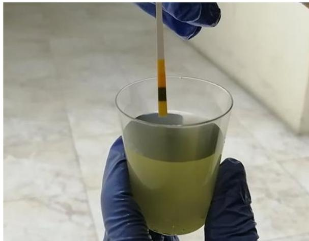
**Ilustración 15:** Prueba del pH del efluente
