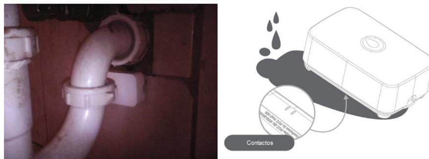
**Figura 15:** Ubicación del sensor de humedad SmartThings
