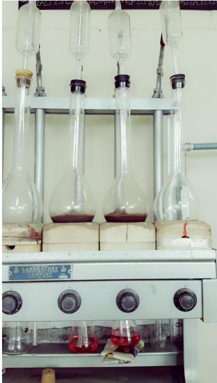
**DESTILACIÓN-DETERMINACION DEL CONTENIDO DE N- EQUIPO KJELDAHL**
