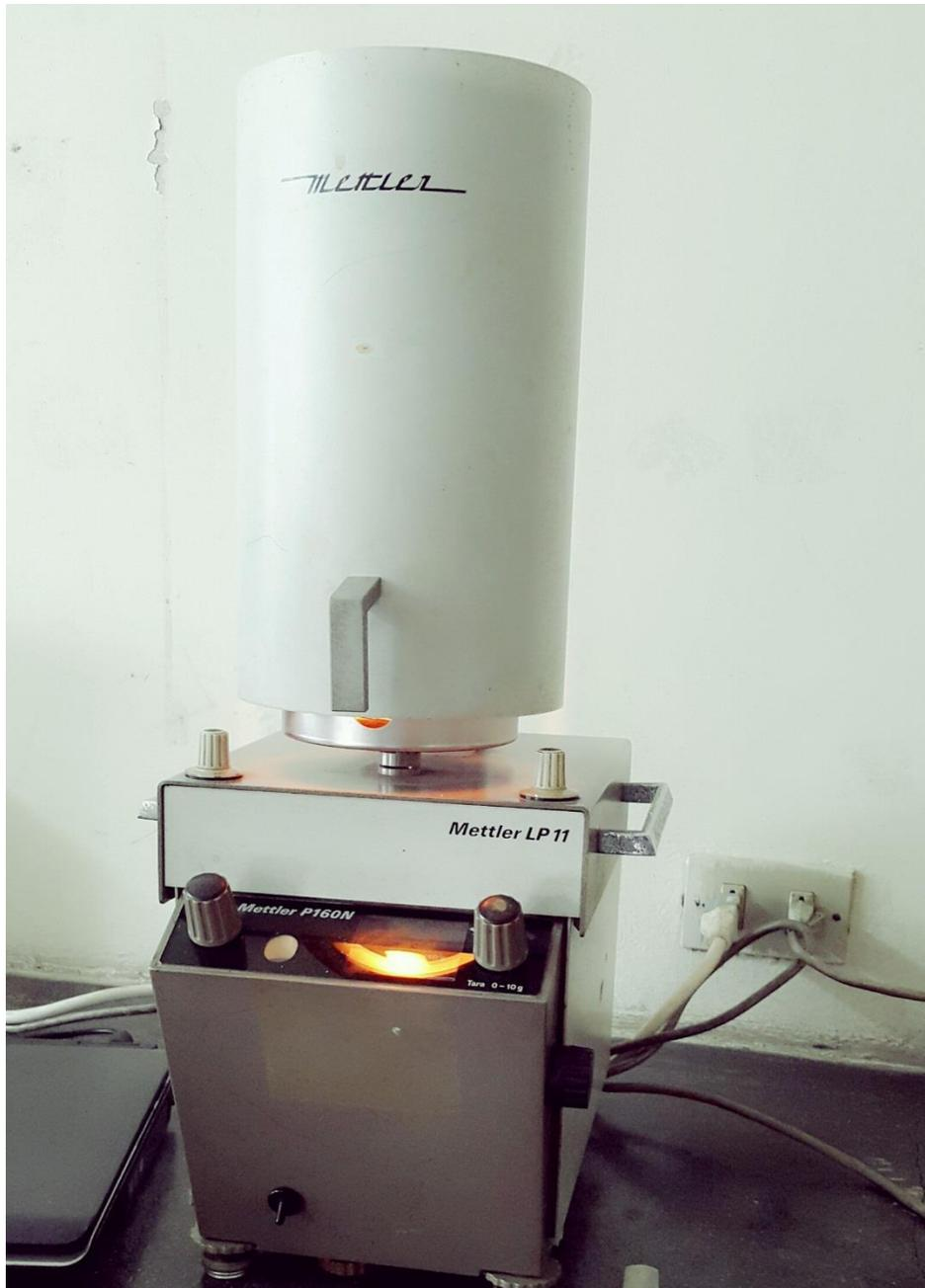
**DETERMINACIÓN DE CONTENIDO DE HUMEDAD – BALANZA DE RAYOS INFRAROJOS**
