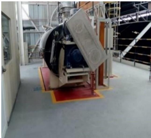
**Figura 5.** Máquina mezcladora donde ingresa la materia prima junto a los materiales aditivos. Información tomada de Mexichem Ecuador S.A., Elaborado por el autor.
