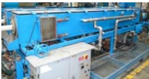
**Figura 8.** *Tina de enfriamiento de la línea de extrusión. Información tomada de Mexichem Ecuador S.A., Elaborado por el autor.*
