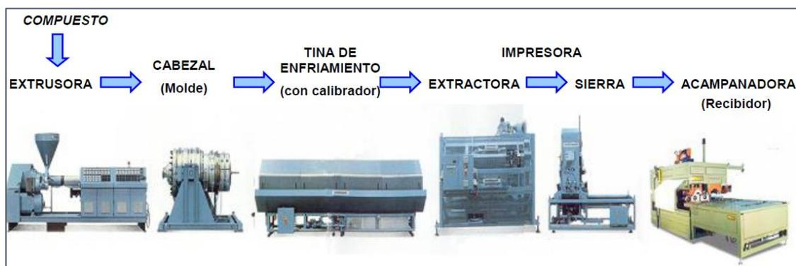
**Figura 13.** Diagrama del proceso de Extrusión PVC. Información tomada de Mexichem Ecuador S.A., Elaborado por el autor.
