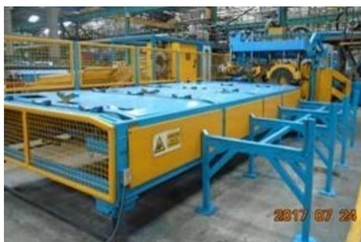
**Figura 11.** Acampanadora para extremos de tuberías. Información tomada de Mexichem Ecuador S.A., Elaborado por el autor.
