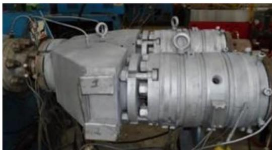
**Figura 7.** *Cabezal o molde de la máquina extrusora que lleva el material a las salidas del cabezal para tomar forma del tubo. Información tomada de Mexichem Ecuador S.A., Elaborado por el autor.*
